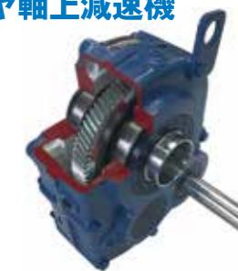
動力軸に直接取り付けでコンパクト、シンプルな機械装置を実現。ヘリカルギヤ軸上減速機は、動力軸に直接取り付けでコンパクト、シンプルな機械装置を実現します。このたび、新形式SMDとしてリリースされました。出力軸中空のため動力軸に直接取り付け可能、芯出し不要。装置全体のコンパクト化に貢献します。垂直、水平、どちらにも据え付け可能です。他社廃番機種との取り付け互換性もありますので、代替品にお困りのお客様は是非ご検討ください。
