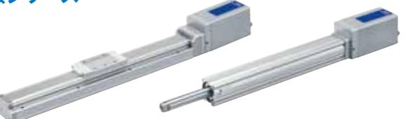
EQシリーズはコントローラー一体型を採用したほか、制御設定をする画面のインターフェースを向上。これまでエア駆動のアクチュエータを扱っていた技術者でも簡易かつ感覚的に使える仕様とすることで電動駆動を導入する障壁を下げています。繰り返し位置決め精度は±0.02mm。工場自動化(FA)全般での用途を想定しています。「かんたん制御」をコンセプトとし、難しいプログラミングは不要。2点停止もしくは中間点の位置を任意で決められる3点停止の動作モードがあります。モータ仕様の最適化、制御方式を見直したことで回転効率を向上。その結果モーター発熱の低減、消費電力の削減を実現しました。
