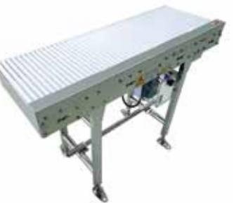
磁石の力で搬送用ローラを回転させるので、モータ容量が半分以下に。カーボンニュートラルにも貢献します。磁石の力で搬送用ローラを回転させる、マルヤスの「レスベヤシリーズ」。平ベルトや丸ベルト駆動方式よりモータ容量が半分以下で同等の能力を得られるため、カーボンニュートラルの観点から近年改めて見直されています。その「レスベヤシリーズ」のステンレス製アキュームローラコンベヤが「GS18H」としてリニューアル。搬送質量は従来機より約17%アップ、搬送速度も選択肢が広がりました。また、より省エネ効果が得られるDCモータ変速も新たに加わりました。搬送用ローラは樹脂製一体ローラを使用。オプションでステンレスローラの設定も可能です。
