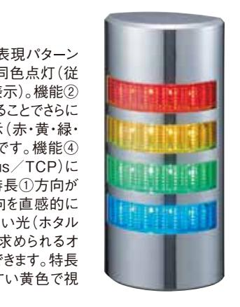
ネットワークを活用して、多彩な表現パターンでお知らせします。機能①全段同色点灯(従来1段だけのアラートよりも強く表示)。機能②点滅表示(緊急時は、点滅させることでさらに強烈に表示)。機能③9色表示(赤・黄・緑・青・空・紫・桃・橙様・白)が可能です。機能④汎用プロトコル(HTTP、Modbus/TCP)に対応しており、構築可能です。特長①方向が見える(流れの表示)で進行方向を直感的に示す事も可能です。特長②優しい光(ホタルのような点滅)で優しい点滅が求められるオフィス、病院等の表示にも活用できます。特長③イエロールーム内でも、見やすい黄色で視認性向上。
