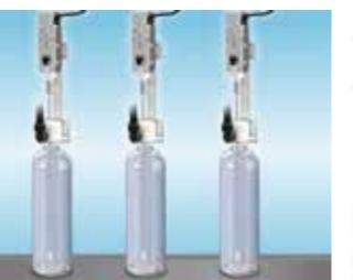
ボトルの内部に付着した異物を除去・回収するために開発された新しいイオンエアブローデバイスです。コンパクトなボディで生成した濃密なイオンをエアに混ぜて細く伸びたノズルから一気に吐出します。濃密イオンがボトルと付着異物の静電気を除去すると同時に近距離からの強力なエアブローが異物を引き剥がし、そのまま気流に乗せて異物をボトル外に排出します。除去した異物は回収機構により全て回収されるため周囲の環境を汚しません。コンパクト設計・省エネ設計により、どのような装置にも容易に取り付けることが可能であり、工場における大量のボトルに対する自動クリーニングに最適なデバイスとなっています。
