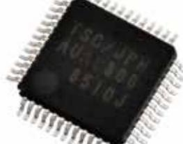
全てのレゾルバ信号方式に対応した高機能なR/D Converterです。新しいR/D変換方式を採用することで、高速・高精度な角度検出を実現しました。
