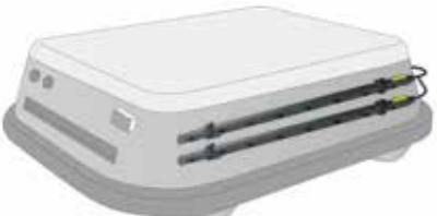
AGV/AMRトリンクはAGV (Automatic Guided Vehicle)とAMR (Autonomous Mobile Robot)等の無人搬送ロボットに有用な静電気対策装置です。従来の固定ロボットは、感電・火災事故や誤動作を防ぐために、ロボット本体をアースして使用します。しかし、移動するロボットはアースの取りようがありません。TRINCは独自の無線アース®技術を取り入れ、ロボットに溜まった静電気を空間に逃がす装置を開発しました。空間に逃がされた静電気は、その後地球に吸収されます。本機は特に強力な無線アース能力を有し、大型のAGVやAMRに対応することができます。
