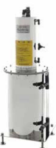
油分を含んだドレン水を処理し、環境負荷の低減に貢献します。エア・コンプレッサから排出されるドレン水(油混じりの廃水)は、そのまま放流すると水質汚濁防止法の排水基準値を超える、環境に大きな負荷が生じます。ドレン処理装置(ドレントーレ)は、エア・コンプレッサから排出されるドレン水(油混じりの廃水)の油分を吸着させ、油水分離し、排出する装置です。ドレントーレなら容易に放流可能な状態[油分濃度(n-ヘキサン抽出物質)5mg/L(5ppm)以下]に処理し、環境負荷の低減に貢献します。※ご購入前に性能の確認を希望されるお客様には、デモ機の貸出をいたします。お気軽にお問い合わせください。
