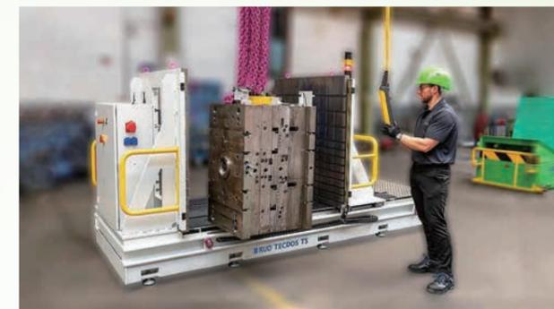
●ツールセパレーター 金型の分離/組み込みを安全かつ効率的に
