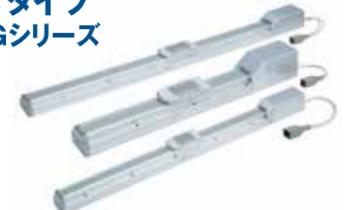
加減速度10,000mm/s<sup>2</sup>、従来比334%。最大速度1,500mm/s、従来比25%アップ。お客様設備のタクトタイムの向上に貢献します。バッテリーレスアブソリュートエンコーダは非常停止後の電源復帰時、原点復帰動作が不要。これにより設備の再起動時間を短縮することが可能です。トータルでのお客様の生産タクトの向上につながる機構となっています。その他の機能としては、エアシリンダにお使いの、D-M9シリーズオートスイッチを搭載することも可能です。本製品はお客様装置のサイクルタイム短縮に貢献できる製品です。
