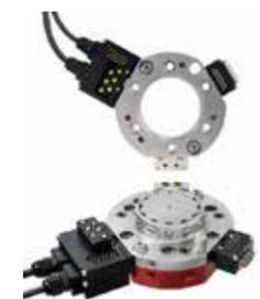
世界トップクラスのガタツキゼロ! ロボットハンドチェンジャーmodel SWRに大型ロボット対応版のmodel SWLが新登場。コスメック独自開発のガタツキゼロ機能を保有し、エア圧力がゼロになっても内部のメカニカルロック機構により、ツールの落下を防止。搬送中の落下事故を防止します。可搬能力は、80kg/120kg/180kg/300kgの4種類を標準ラインアップしており、大型ロボットに対応できます。180kg/300kg可搬タイプは、電極取り付け箇所を3箇所準備し、さまざまなツールチェンジに対応。取り付けはISO規格のメカニカルインターフェースに準拠し、一致するロボットへの直接取り付けが可能です。
