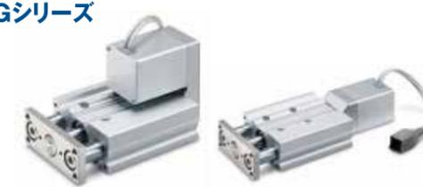
電動アクチュエータのバリエーションに、高タクト対応高剛性ガイド付きロッドタイプが追加となりました。サイズ40では最大150kgのワークが搬送可能です。バッテリーレスアブソリュートエンコーダを搭載しているため、電源復帰時に停止位置からの再始動が可能となり、バッテリーのメンテナンス工数が削減できます。モータストレートタイプでは、D-M9□型、D-P3DWA型のオートスイッチに対応しており、リミット確認、中間信号確認に利用可能です。従来機種よりも剛性をアップした製品になっており、従来よりも重いワークのストップ機構などにも使用可能な製品です。
