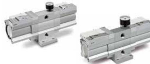
工場エアを部分的に増圧する増圧弁に、省エネに貢献できる新機種が発売されました。従来品では増圧時に排気していたエアを再利用することにより、最大40%空気消費量を低減できます。また、従来機種と比較し、作動音が80dB(A)から65dB(A)に低減されており、作業環境の改善に貢献可能です。水平、垂直どちらの取り付けも可能なため、様々な現場で簡単に導入ができます。従来機種と取り付け互換性があるため、同社従来機種からの置き換えも簡単です。
