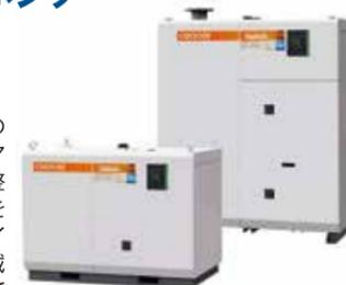
水冷式KCEシリーズは、高効率の非接触ツインロータと真空エア使用量に応じて回転数を調整するインバータ制御により電気代を大幅に削減した大流量ドライ真空ポンプです。オリオン機械として初めて水冷式を採用しており、ポンプと筐体内を冷却し周囲への放熱を最小限にできるため、ポンプ設置場所の空調負荷を下げると同時に運転音も抑制しています。工場内の温度上昇を避けたい電子部品製造や食品容器成型など、幅広い用途で使用可能です。最大10台までの台数制御に対応(要別売部品)、データ記録にも対応しています。
