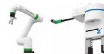
丸みを帯びたデザインが目を引く、ファナックCRX専用ロボットハンドです。ISO/TS15066に準拠した設計がなされています。片爪ストロークは10mm、最大把持力は190N(4段階設定)、デジタルIO制御、コントロールはグリッパに内蔵しています。ロボットフランジに直接取りつけること、グリッパのケーブルをツールIOにそのまま接続することに加え、グリッパにはあらかじめ爪がついているため、ご購入後すぐに、簡単にご使用可能です(お客様ご自身でも爪の交換は可能です)。また、セルフロック機構により、停電やケーブルの破損などで電力の供給が突然途切れてもワークを落としません。設備やワークの破損を防ぎ、安全性を保ちます。把持力や耐久性、ご使用方法でお悩みの方はお気軽にご相談ください。
