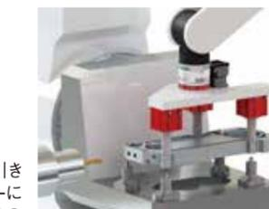
ワーク穴を内張りして把持し、引き込んでクランプします。エアプルーによる異物(切り粉やクーラント等)の侵入を防止し、切削加工の環境下での使用やダイカスト等の鋳物ワークの搬送に最適な搬送用ロボットハンドです。オートスイッチによる動作確認も可能です。ロック側にバネを内蔵し、停電やエアホース等の切断によりエアの供給が断たれても搬送物を落下させません。
