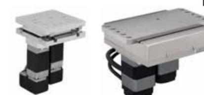
X軸、Y軸に内蔵されたカムを回すことで高速位置補正を実現しました。従来のステージ構成イメージを覆す「ステージ横にモータの飛び出しがない」スタイル。ステージ下にモータを配置することでステージサイズのスタイリッシュなレイアウト構成を実現。周辺機器との間隔を最小限に抑えます。近年、電子部品などワークの微細化に伴う装置の小型化、高精度化が求められています。ワークを搬送しながら位置や姿勢を画像で確認し、位置補正して供給する緻密な作業が同社ピック&プレースユニットと組み合わせて実現可能です。また、単軸ロボットとの組み合わせでも装置の小型高速位置補正の実現に最適なユニットです。
