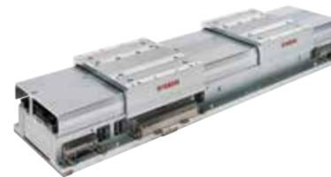
ワークを運ぶだけの時間は必要でしょうか?リニアコンベアモジュールLCMR200で搬送工程をロボット化。ヤマハはコンベアを「流す」から「動かす」へと変革し、無価値な搬送時間を限りなくゼロに近づけます。劇的なタクトアップで生産量の増加を図ることができるため、車載や電子・電気、最近では食品業界でも採用されています。また、トレーサビリティ対応に貢献している点も採用理由の一つです。各スライダには個別IDが付与されており、現在位置を常時出力することが可能です。さらに、上位機器で各工程の情報とスライダIDを紐づけすることで、治具パレットのコード読み取りが不要に。結果、コードリーダーの数が減少し、ソフト制作工数の削減にもつながります。
