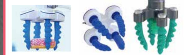
人間の指のような感覚で、ワークに合わせた繊細かつ柔軟な把持・搬送可能なロボットハンド。専用の制御ユニットを使用することで、繊細なワークをより優しく把持したリ、複数種のワークが混載されたラインでもそれぞれに最適な搬送を実現できます。本体はIP68クラスの防水性能をもち、分解せずに位置洗浄が可能。フィンガー部分はFDA規格に準拠した材質で、食品に直接触れるような工程でも使用することが可能です。さらに、EHEDGに準拠し、より洗浄性に優れた「高衛生モデル」をラインアップ。段差などへの汚れの堆積を予防し、特に衛生的な環境が求められる工程でも使用が可能です。野菜などの生鮮食品、サンドウィッチなどの崩れやすい食品ワークなど、一つのハンドで多様なワークに対応することができ、ハンドの設計や付け替えのためのコストの削減にも寄与します。
