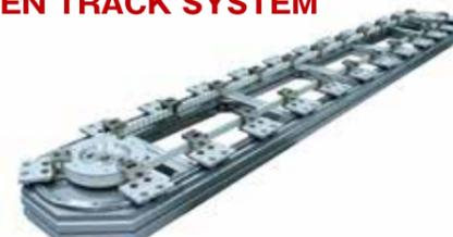
曲線レールや直線レール、Vベアリングだけでなく、ベルト+プーリー方式での駆動源及び接続パーツを組み合わせた循環搬送システムです。従来、個別に設計していた各部品の選定工数や現場での組立工数の減少に繋がります。搬送距離や全体スペースは、キャリッジテーブル数とキャリッジ間距離によって決まります。お客様の仕様に合わせて都度選定する、受注生産品です。形状はオーバル循環型と長方形循環型から選ぶことができます。エンドレス軌道の循環搬送システムとしてご検討ください。
