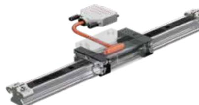
測定センサーが内蔵された一体型測長機能付きリニアガイドです。従来のエンコーダー分離型と比べ、外部に取り付ける必要がないため、設置スペースが大幅に減少できるだけでなく、部品点数の減少も可能となります。また、衝撃や振動、オイル、ダスト等の過酷な環境下でも安定した測定機能を維持します。磁気式エンコーダーを使用しており非接触型測定システムのため、メンテナンス性に優れています。
