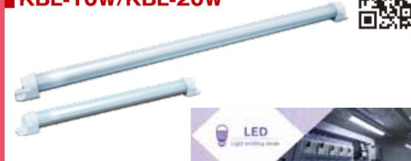
大型の自立制御盤やキュービクル用のLED照明。蛍光灯からの置き換えとして開発製造されました。使用温度-25~60℃のワイドレンジ。防水規格はIPX5と対応範囲が広いので、設計自由度がより高く安心です。AC100~240V、50/60Hz対応。灯具用の変圧器等は不要。日亜化学製「NICHIA 757」を使用しているため白色LED特許問題もクリアしています。LED特有のつぶつぶ感の無い、きれいで明るい発光(LBL-10W:600lm・KBL-20W:1000lm)。背面アルミ材が肉厚で剛性も高く、盤の高品質感を引き立てます。リード線は2m、自立盤への設置も余裕です。
