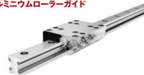
ASK-フランケ アルミニウムローラーガイドは、高速性、軽量化が求められる仕様に適したリニアガイドシステムです。特殊形状のローラーベアリングが理想的に配置されており4方向等荷重、高速で滑らかな走行(最高速度:10m/s)を実現します。製品の主要部材にアルミニウムを採用しているため、スチール材の製品と比べ約40%の重量削減となります。さらに、防錆仕様、非磁性仕様、真空仕様、無潤滑仕様など特殊環境対応の製品が揃っており設計の幅が広がります。
