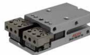
MEPAC平行開閉チャック インフィニティタイプは、MEPACシリーズの優れたクランプ機能のままに、より高精度・摺動特性に優れた無限軌道型リニアガイドを搭載して高性能・使いやすさを実現。複動タイプでエア圧0.1MPaからの把持動作が可能。フィンガ側面に爪を取り付け可能な「フラットタイプIP」を用意。本体を横に寝かせた状態で取り付ければ薄型使いも可能です。爪の取付姿勢を選ぶことができるので工程に合わせた最適なレイアウトが可能です。ワークをチャックの近くで安定把持させたいお客様にも最適です。
