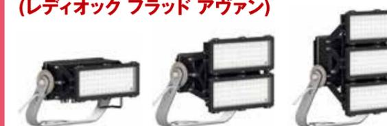
「レディオック フラッド アヴァン」は、軽量・コンパクトでハイパワー、スポーツ施設向けLED投光器において最高クラスの固有エネルギー消費効率166.2lm/Wを誇る高効率化を実現しました。電源ユニット一体形なので、別置電源ユニットのスペース確保や設置作業、本体と電源ユニットとの結線作業が省略できます。最も明るい「メタルハライドランプ1,000W相当」から、「水銀ランプ700W相当」まで、3つの明るさ(400クラス、250クラス、150クラス)、配光は4種類(狭角タイプ・中狭角タイプ・中角タイプ・広角タイプ)を取り揃えた計12形式をラインアップ。用途に合わせて選定いただけます。海岸線から300m以内の施設にも使用可能な重耐塩仕様のLED投光器です。
