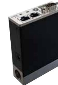
自社開発の高感度流速センサ「マイクロフローセンサ™」を搭載することにより、0.3secの高速制御性を実現した気体の流量コントローラです。新しいマスフローコントローラのスタンダードを目指し、装置搭載用として使いやすさを追求しました。F4Hでは電気電子部品の製造装置や各種分析装置・培養装置などで必要とされる機能に絞り込み、小型バルブの採用、基板レイアウトの工夫を行うことで従来製品比50%の小型化を実現しました。また、標準で汎用のデジタル通信機能を搭載し、他の機器と市販のLANケーブルで接続が可能です。これにより、配線も効率化でき、作業工数の削減にも貢献します。
