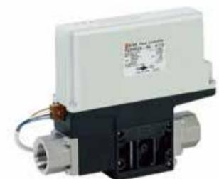
水の流量を自動調整可能な、水用流量コントローラです。流量制御範囲は0.5～4.0L/min、2.0～16.0L/minの2種類をラインアップしています。流量制御精度は±5%F.S.、応答時間は10s以下、ノンゲリンス仕様です(同製品単体での全閉機能はありません)。アナログ電圧入力信号DC1～5Vにて流量制御が可能です。また、流量測定結果もパルス出力により出力可能です。水を複数ラインで流した場合、元圧の変化などにより流量が不安定になります。複数ラインの流量の安定化に貢献する製品です。
