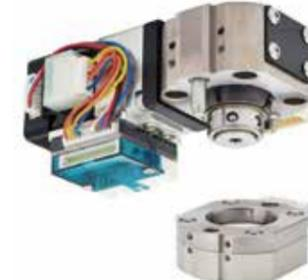
ロボットのオール電動システムを実現する電動ツールチェンジャーです。ドライバ内蔵型で省配線・省スペースを実現した電動ハンドチェンジシステムで、メカ部は独自のノンバックラッシュ機構で連結時のガタツキゼロかつ高精度を実現(位置再現精度:3μm)。24時間連続運転を実現するケタ違いの剛性と耐久性を兼ね備えています。また、万が一の停電時にもツール落下を防止するセルフロック機構も内蔵。同社製の各種電動ハンドとの併用でスマートな電動システムが完成します。
