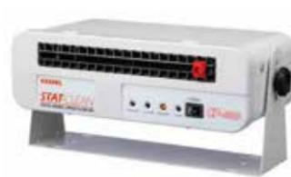
静音性に優れワイドエリアをカバーし、遠くまでイオンを届けることのできるクロスフローファンCF-300がリニューアル。従来品より大型のクロスフローファンの採用により、より遠くまでイオンを届けることができます。クリーニングブラシ付きで、日々のメンテナンスを容易にできる改良版です。コロナ放電式ACタイプで、小型高周波トランスを採用、効率よくイオンが生成されます。幅広く、均一な風を送り出すクロスフローファンとイオンの流れを考慮したフロントカバー設計により、優れた除電性能を実現。風量調整は無段階に行えます。フロントカバーにスライド式のクリーニングブラシを装着、いつでも針電極のメンテナンスが可能。ファンモーター異常停止と高電圧出力停止の監視機能を装備した安全設計。安全なDC24Vの低電圧入力で、自動機等の内部DC電源を利用することもできます。作業台、ベルトコンベアライン、セル生産台など幅広い用途で使用が可能です。
