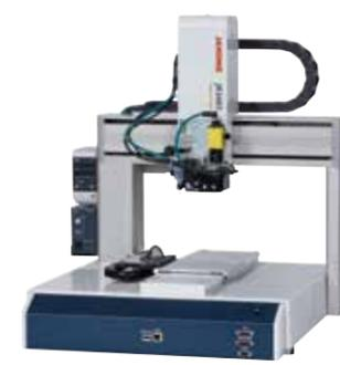
高精度・高剛性の卓上ロボット JR3000シリーズに、位置補正用のCCDカメラとレーザー変位計、ニードル補正センサを搭載し、1つのパッケージにしたことで、面倒な機器の選定やシステム構築にかかるユーザーの手間を大幅に軽減した塗布用ロボットです。オリジナルPCソフトウェアで、各種位置補正用機器の設定からロボット本体の設定、ティーチングまで、アイコンを用いて誰でも簡単に行えます。通常の位置ズレ補正に加え、塗布面が波打ったワークなどにも一定のクリアランスで正確な塗布が行える機能や、PCに映し出された拡大画像によりティーチング時の位置設定が正確に行える点なども特長です。
