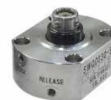
高精度な繰返し位置決めとクランプを瞬時に行う小型ロケットクランプです。固定・位置精度出し・精度検査に必要な時間と作業によるバラツキをなくし、短時間で簡単にパレットやジグの交換が可能です。パレットの自動段取り替えにも最適です。サイズは、2種類から選択可能です。【仕様】①繰返し位置決め精度: 0.003mm ②使用圧力範囲: 0.4~1.0MPa ③使用流体: ドライエア
