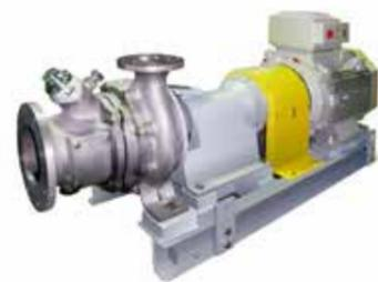
液体中の固形物の破砕・微細化・圧送ができる湿式破砕機サンカッタの製造販売を開始しました。回転刃のカッターペラと固定ブレードで一次粗破砕をし、固定刃リングとインペラ外周間で二次破砕を行います。三次破砕はグリッドの選定から最終粒径の選択が可能。化学・食品・製紙・鉄・非鉄・水処理と様々な業界で、配管の詰り防止・固形物粒度の破砕及び均一化・溶解時間の短縮・有価物の回収などの用途に使用できます。
