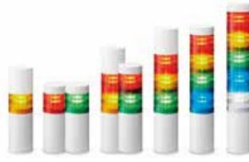
「お客様にとって使いやすい製品作り」をコンセプトに、φ40・50・60・70mmの4サイズを全面リニューアル。充実のバリエーションと、短納期・安定供給を実現しました。安心の2年間無償修理対応。特長としては①光：新設計のレンズで、効率的・効果的な発光を実現。製造現場でより明るく報知②音：業界初の円筒型無孔性ブザーを採用。ブザーも4音搭載。取り付け位置が最上部になり、アラームが360°どの方位からでも聞きやすくなった③使いやすい：新設計のスタック構造で、追加ネジ不要。工具レスで簡単に色替替や増・減段が可能④強度：凹凸形状を無くした新デザインにより、ほこりや水、汚れの侵入を防ぎます(IP65)。材質はポリカーボネート、配線も断線を防ぐキャプタイヤケーブルを採用。過酷な使用環境でも安心、などがあげられます。
