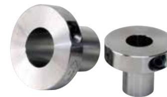
従来製品を細部まで見直すことでリードタイム1/5、製品コスト1/2と納期短縮・コスト低減を実現。さらに無電解ニッケルめっきを施した簡易防せい仕様タイプの拡充を進めより使いやすくなりました。また、従来の性能はそのまま、軸とハブの締結はボルト1本を締め付けるだけで瞬時に完了。ハイドロ方式による均等な締め付けで、誰でも簡単に取り付けが可能です。一般産業機械の締結具として、繰り返しの着脱が必要な場所や高精度な取り付けが要求される箇所に使用できます。機械組み立ての軸とハブとの締結作業が飛躍的に効率アップします。許容トルク46~3300N・m。穴径φ15~60mm。18サイズ。
