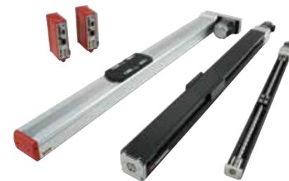
ボールねじ軸の大径化・大リード化による最高速度2,500mm/s、加減速度最大2G、最大1,500mmのロングストロークを実現。ボールねじ軸の大径化により、同等サイズの従来品に比べ、定格出力の大きいモータも使用可能になりました。
