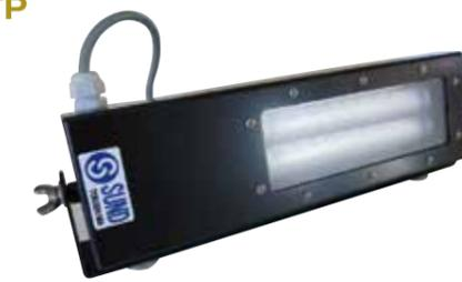
水銀灯100Wクラス相当の明るさで、消費電力はわずか14W!保護等級はIP65なので、粉塵の多い場所や水のかかる場所でも使用可能です。雷サージ耐量10KVを備えており、屋外でも使用可能です。入力配線は、標準3mです。電気用品安全法適合製品です。明るく、AC100/200Vで使用できるので汎用性が非常に高い照明です。VLE同様、安心のMADE IN JAPANです。
