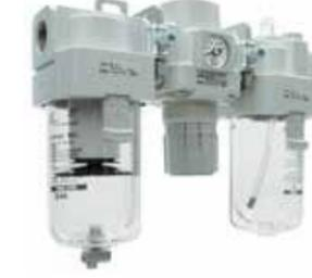
圧縮エアの異物除去・調圧・潤滑を行うF.R.LコンビネーションACシリーズは、ケースガードに透明なポリカーボネートを採用した二層構造になっています。これにより360°の目視確認が可能です。また、ケースを劣化させるような薬品や油が舞う環境でも、内圧が加わるケースには直接付着しないため、ケース破損のリスクを軽減できます。さらに、今回からオーダーメイド仕様が多数追加されました。-30℃まで低温環境に耐える(-X430)、80℃まで高温環境に耐える(-X440)、2.0MPaの最高使用圧力を持つ(-X425)、クリーンルーム仕様(10-)などです。他にもオーダーメイドが多数追加され、使いやすくなっています。
