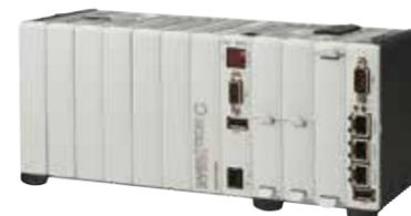
高速フィールドバス\*1 EtherCATインタフェース、高速処理CPU搭載のモーションコントローラです。1台のコントローラで、2台の6軸多関節ロボットを制御できます。山洋電気従来品\*2に比べて処理能力は約2倍です。また、100Mbpsの高速フィールドバス\*1により、山洋電気従来品\*2に比べて通信が高速になり\*3、より精度の高い制御を実現しました。ロボット、搬送装置、半導体製造装置、一般産業機器などに最適です。\*1 装置とコントローラ間の信号のやり取りを、デジタル通信を用いて行う規格のこと。\*2 山洋電気従来品: コントローラ [SANMOTION C] 型番: CP242-A。\*3 モータの数が32軸の場合、通信周期は1ms。
