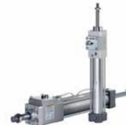
六角レンチのみで手動ロック開放、保持が可能なロック付きシリンダが新発売されました。手動ロック開放機構を内蔵し、ロック開放ポートにエアを加圧せず、六角レンチにて開放、保持が可能です。そのため、装置取り付け、メンテナンスが容易になりました。またロックユニットとシリンダが分離構造になり、ロックユニットのみの交換が可能となったため、メンテナンス性が向上。従来のロック付きシリンダMNBシリーズと比較し、保持力も最大14%向上しています。エアの供給停止、停電時に落下防止や緊急停止により、ワークの保持やストローク位置保持の安全機構として使用可能なシリンダです。
