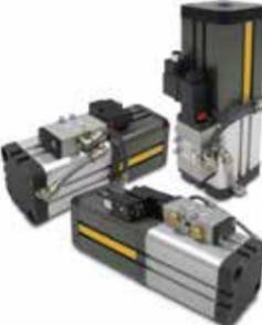
自動車製造工場などで使用されるスポット溶接装置において、日常的に必要なチップ交換時の冷却水吹き出しを防止するユニットです。チップ交換時に吹き出した冷却水は、例えば感電、作業者のスリップ、溶接エリアの悪化、製造された製品へのダメージ等の潜在的危険、リスクがありますが、溶接装置の冷却水循環回路に接続し、WRAを駆動することにより冷却水システム内の水圧を下げ、チップ交換時に冷却水が吹き出すことを防ぎ、安全な溶接エリア環境、リスク低減に効果を発揮します。
