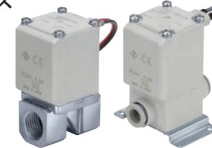
大流量、小型、軽量化した直動形2ポートソレノイドバルブです。適用流体は空気、中真空、水、油です。従来品との比較で、流量は20%向上、高さ寸法は10%低減、質量は30%低減を実現しました。ボディ材質は空気用がAl、樹脂、水・油・中真空用がC37 SUSで樹脂ボディはワンタッチ管継手付です。保護構造はIP65(リード線取出しファストタイプ、端子部はIP40)。DCタイプの消費電力は4.5W(サイズ1)、7W(サイズ2)、10.5W(サイズ3)と低消費電力です。また、ゴムダンパ採用により金属音を低減した静音構造になっています。
