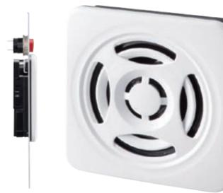
製造ラインや装置の小型化にあわせた業界最薄の奥行き19.9mmの薄型コンパクトデザインです。薄型ながら87dBの大音量を実現。前面パネルで簡単にボリューム調整も行えます。また、わずか3.5W(最大)の低消費電力で電源への負荷も低減させました。前面からの作業だけで、取付・取り外しとボリューム調整ができる為設置及びメンテナンス工数を大幅に削減できます。SDカードスロットが標準装備しSDカードを使用することでMP3データの書き換えが可能です。
