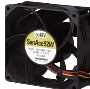
IP55の防水・防塵性能を持ったファンです。屋外などの厳しい環境でも安定した冷却性能を保ちます。最大風量5.05m<sup>3</sup>/minの高風量ありながら、消費電力39.4W、音圧レベル64dB(A)の省エネルギー・低騒音を実現しました。外部からファンの回転速度をコントロールできるPWMコントロール機能付きです。屋外で使用する装置や、熱交換器に最適です。
