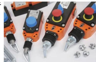
非常時にロープを引くこと、もしくは非常停止押しボタンスイッチを押すことにより安全接点を強制的に引き離し機械を停止させる非常停止スイッチです。ロープが広範囲をカバーするためコンベア周りなどの設置に最適です。コンベア側面に多く設置されている制御用ロープスイッチは、ロープが切れると動作しませんが、ZSシリーズは、テンション制御により、ロープが緩んだり切れても安全側に動作するので安心です。また、種類が豊富にあり、使用条件に応じた機種をお選びいただけます。広範囲に非常停止帯を確保し非常停止スイッチを汎用しより経済的です。
