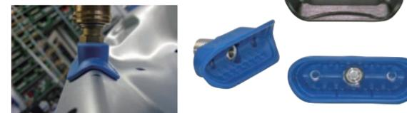
製品の縁部分や曲面にフィットするために吸着面を「く」字型に設計開発した真空パッドです。フラットパッドではカバーすることが困難だった縁部分や曲面の吸着搬送に最適です。吸着面の凹凸が油の逃げ道となり、油膜の張った製品の吸着時にも滑りにくく、高い吸着力を発揮します。汎用的なニトリルゴム製パッドの他、250度まで吸着可能な耐熱性の高い材質もラインアップしています(HT2材)。高温耐性に優れたHT2製パッドは、熱間加工後の搬送に適しています。HT2材はシリコンを含んでいないため、吸着後の塗装時に問題となる吸着跡の浮き上がりを抑制します。
