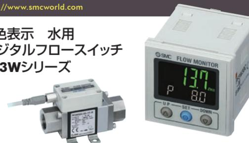
3色表示水用デジタルフロースイッチのバリエーションを追加しました。①流量調整弁、温度センサを一体化②センサ部とデジタルフローモニタ部分分離型をラインナップ③塩化ビニル製配管タイプをラインナップしました。適応流体は脱イオン水(純水)、薬液等です。流量範囲は10~100L/minです。一体型、分離型をシリーズ化。従来製品比40%の小型化を実現し、配管スペース削減に貢献します。使用流体温度は0~90℃です。温度センサの表示可能範囲は-10~110℃、設定最小単位は1℃です。また、測定流量100L/minを追加しました。3色表示のデジタルフローモニタは、最大10台まで同時コピーが可能で、設定工数削減や設定値の入力ミスを低減します。
