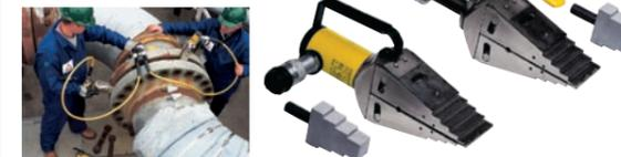
フランジ配管ガasketやフランジ面の清掃バルブ交換のためにフランジの隙間を広げるツールです。レスキュー工具としても最適です。ウェッジを一体化することで摩擦を減少させ円滑なウェッジの平衡にした動きがフランジの損傷やスプレッドアームの動作不良を削減しました。ウェッジが重なりあった独特な設計のためステップが屈曲や、ジョイント部からスリップが起こることを防ぐ安全設計です。階段形状に設計されたスプレッドアームの各ステップに全負荷を受けて隙間を広げることが可能です。FSM-8(手動式スプレッダ)にSB-1(安全ブロック)とSW-22(ラチェットスパナ)、FSH-14(油圧式スプレッダ)にはSB-1とRC-102(単動シリンダ)が標準装備されています。
