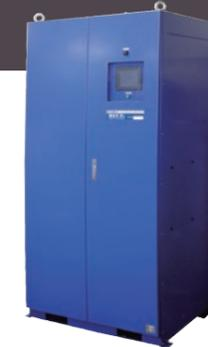
高純度の窒素ガスを発生させる装置です。膜分離方式の場合には窒素純度90~99.5%程度、PSA方式の場合には99~99.99%程度の窒素ガスを作り出す事が出来ます。また、窒素ガス発生装置は原料空気として圧縮空気が必要となりますが、工場に余剰空気がある場合にはコンプレッサ別置形の窒素ガス発生装置を選定することにより低コスト・省スペースを可能とします。さらに、機種によっては窒素ガス使用量に応じて省エネ運転を行いますので、従来機種と比べて省エネ・CO<sub>2</sub>削減の効果が期待できます。
