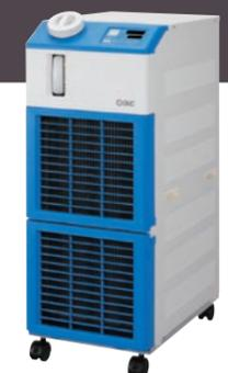
小型・省スペース、軽量なサーモチラーです。コンパクトタイプに新たに冷却能力4700W/5100W(50/60Hz)のHRS050を追加しました。従来機種であるHRG(C)005との比較で、製品面積32%、製品容積42%、質量43%削減しました。温度安定性は±0.1℃、設定温度範囲は5~40℃で、高揚程ポンプ仕様を標準化しています。単位切換え、タイマー運転、液面低下検知など便利な機能を搭載しています。また、自己診断機能と点検画面でメンテナンスが容易です。他に漏電ブレーカ付、脱イオン水(純水)配管対応、自動給水付のオプションを用意しています。
