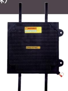
エアもしくは水で重量物を引き上げるリフティングバックです。緊急災害、レスキュー工具としても最適です。使用時の安全性を高めるアラミド繊維Kevlarで強化、また油や化学薬品に耐えることのできる非伝導性ラバーの強力な摩擦面でスリップを防ぎます。必要な揚程に合わせて9種類の多彩なサイズモデルと揃えました。246kN以上リフティング能力の製品にはナイロンストラップと丈夫な移動用の取っ手がついています。安全カプラ付専用ホースを経由してエアを供給し偶発的なエアの切断や放出を防ぐことが可能です。
