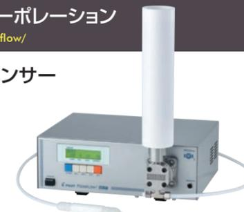
接着剤、シール剤をはじめとする中粘度液体を、液体の温度、粘度、比重の影響を受けにくく、定量に吐出できるトロコイドポンプ方式ディスペンサーです。ポンプの動作は、ポンプに取り付けられたカートリッジ(材料)から、密封されたポンプ内のローター間で行われる空間容積の増加により材料を吸引して、ローターの回転により吐出方向に加圧して押し出します。このため、空気に反応して硬化する材料でも塗布が可能です。吐出後は、ポンプを逆回転させて液タレを防ぎます。塗布作業に優れたハンドホルダーとAC電源により使用できます。主な用途は、①シリコン剤での止水シール及び接着②一液性RTVゴムでのコーティング③アクリル変性シリコンでの部品固定、防水シール等です。
