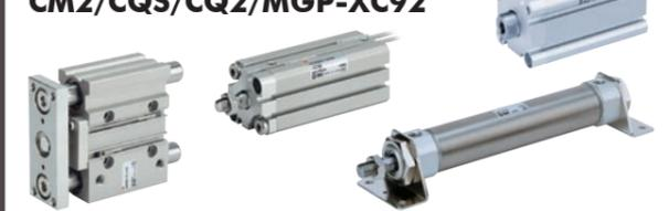
セラミック粉、トナー粉、紙粉、金属粉(溶接スパッタを除く)等の微小粉体が舞う環境に対応可能なシリンダです。ロッドカバー部にルブリテナーを2ヶ装着し微小粉体30μm以下の侵入を防止します。ルブリテナーによりピストンロッドにグリース膜が形成され耐久性が向上します。CM2、MGPの全長寸法は強力スクレーパ付(-XC4)と互換性があります(CM2は標準品と同寸法)。対標準品で耐久性が4倍向上します(標準品、強力スクレーパ付との比較)。適用シリンダはCM2(φ20~40)、薄形シリンダ/コンパクトタイプCQS(φ12~25)、薄形シリンダ(φ32~100)、ガイド付薄形シリンダ(φ12~100)です。
