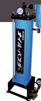
圧縮空気用高性能オイルミスト吸着捕捉装置です。油分を嫌うような現場では、オイルフリーコンプレッサを使用するのが一般的ですが、オイルフリーコンプレッサは給油式コンプレッサに比べ価格が高くメンテナンス費用も割高です。フクハラ製オイルバスターを給油式コンプレッサの後(ドライヤ通過後)に取り付けることにより、オイルフリーコンプレッサ同等の品質にする事が出来ます。主な特長は、①電源が不要なので接続が簡単②オイルレス確認器によりオイルの排出の有無を確認出来る③出口側オイルミスト濃度が0.0005wtppm以下④フィルター槽は槽ごと(カートリッジごと)交換で、さらにリユース方式のため、二次産廃が不要、などです。
