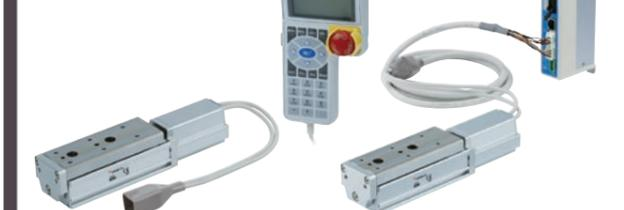
電動スライドテーブルにモータストレート形を追加しました。従来のモータ折返し形と比較して、幅方向を最大45%短縮しました。最大加減速度:5000mm/s²、最大速度:400mm/sとタクトタイムの短縮が可能です。繰返し位置決め精度は±0.05mm、最大押し当て推力は180N、速度制御・位置決め点数は最大64点です。動作のための基本設定が入力済みの専用コントローラ付です。また、オプションのティーチングボックス使用時は、位置と速度の2項目で設定が完了する簡単設定です。
