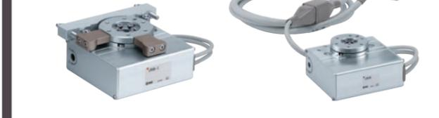
薄型、省スペースを特長とする電動ロータリテーブルです。ワーク、本体取付が容易で、揺動角度90°、180°仕様の外部ストップ付を用意しています。位置と速度の2項目で設定可能(ティーチングボックス使用時)で初期パラメータ設定済の専用コントローラ付と、簡単設定を特長としています。最大速度420°/sec、最大加減速度3000°/sec2とショックレス・高速駆動が可能で、繰返し位置決め精度は±0.05°です。揺動角度は320°(310°)、180°、90°です。速度・加/減速度・位置決めは最大64点です。テーブル停止後、電力を40%自動低減する省エネ設計です。
