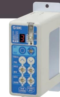
プログラム不要で、パソコン・ティーチングボックスを使わずに電動アクチュエータの動作設定が可能です。位置決め点数14点に対応し、速度・加速度は16段階調整が可能です。また、ロック付の電動アクチュエータにも対応し、3段階の押当推力の設定が可能です。電動グリッパ(LEHシリーズ)、電動スライドテーブル(LESシリーズ)、電動アクチュエータ/ロッドタイプ(LEYシリーズ)、電動アクチュエータ/スライダタイプ(LEFシリーズ)、電動ロータリテーブル(LERシリーズ)に対応します。
