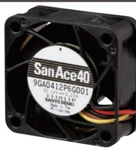
高風量・高静圧・省エネルギー・低騒音を実現した40mm角×20mm厚の冷却ファンです。山洋電気従来品に比べ、最大風量は約20%、最大静圧は約107%向上(9GA0412P6G001)、同風量時の消費電力は約50%、騒音は4dB(A)低減(9GA0412P6H001)しました。定格電圧はDC12Vで、2種類の回転速度をラインアップしています。通信装置、サーバ、ストレージ、電源装置などの装置の冷却に最適です。外部からファンの回転速度をコントロールできるPWMコントロール機能付きです。
