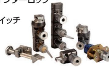
予め定義された操作シーケンスが必要な安全アプリケーションで電力遮断、キー交換、およびインターロック用に設計されたメカニカル式のインターロックです。危険な機械を点検する際に作業者の安全を確保し、万が一の事故を未然に防止するための安全スイッチです。堅牢なステンレス製で、豊富な各種キー交換やアイコンレータでアプリケーションに対応します。ドアを開ける前に電源遮断を確実に実行させるため、複雑な安全回路が不要です。ドアのインターロックは、メカ式なので電気配線は不要です。鉄鋼、プラント、重工業などの電気配線の設置が困難な環境下に適します。
