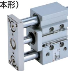
ガイド付薄形シリンダMGPシリーズが軽量化をはかりリフレッシュしました。ガイドロッド短縮、プレート厚み変更により質量を最大17%削減しました。ガイドロッドを最大22mm短縮したことで、シリンダ取付時の逃がし加工量削減と省スペース化を実現しました(MGPM40-25STの場合)。性能・強度(剛性)、取付寸法は従来品MGPシリーズと同等です。丸型オートスイッチ、耐強磁界オートスイッチがスペースなしで直接取付可能になりました。すべり軸受(MGPMシリーズ)、ボールプッシュ(MGPLシリーズ)、高精度ボールプッシュ(MGPAシリーズ)の3種類の軸受が選択可能です。また、4種類の取付、2方向からの配管が可能です。
