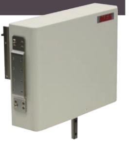
ワークの供給など「ワークを運ぶ」作業に最適な、高速・安定搬送を実現するバルス制御モータ式のピック&ブレースユニットです。微小部品や小型部品の高速搬送ユニットとして多くの生産現場で好評のコンパクトタイプに、今回「ロング搬送」モデルを追加しました。「ロング搬送」110mmを「高速」0.6sec〜で、さらに「コンパクト」ボディの小型化も実現しています。特長は①「小電力」1モータでX&Z軸を駆動するため、2モータ駆動と比較し大幅節電②「簡単制御」1モータのため制御機器コスト・作業負担など大幅に削減③「長期安定搬送」シンプルで剛性の高いメカニズムで長期に亘り安定搬送を実現します。
