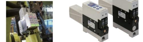
省エネ機能とシステム停止前の不具合検出が可能な自己診断機能を搭載した真空エジェクタです。一定の圧力に達するとエアの吸込みを停止するエアセービング機能を備えており、エアの消費を抑えた省エネ運転が可能です。また搬送システムに不具合が生じエア漏れが増加した場合、バルブの消費を防ぐために自動的にエアセービング機能を解除します。システムの異常はインディケータランプによって示されるため、エア漏れが拡大する前に対策を講じ、システム停止を未然に防ぐ事が可能になります。モニタリング結果は外部に出力でき、設置場所以外での状況確認も可能です。粉塵・磨耗耐性にも優れており、メンテナンスのコストも抑えることができます(保護等級IP65)。
