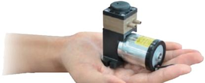
コンパクトな形状の長寿命な液体ポンプです。DCモータ駆動の液体ダイアフラムポンプに、ブラシレスモータ仕様が増えました。最大流量は400ml/minで、従来製品と比較して約10倍の耐用時間になりました。また、脈動吸収機構内蔵により接続配管の振動を低減しました。自吸式で呼び水不要、気体混入もOKです。直流駆動のため機器への組み込みが容易で、化学、医療、食品、水処理などの分析機器組み込み用として最適です。その他にも洗浄機や滅菌機用の液体搬送、工業用インクジェットプリンタのインク搬送など、幅広い用途に使用できます。
