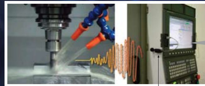
操作盤側面に取り付けられた集音用マイク
