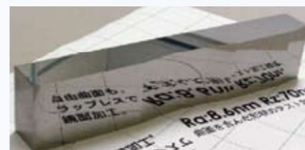
自由曲面鏡面ワーク： 面粗さ Ra:8.6nm, Rz:70nm(被削材:SKD-11)
