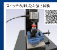
スイッチの押し込み強さ試験
