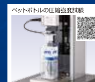
ペットボトルの圧縮強度試験
