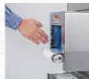
X線漏洩防止カーテン、 手挿入監視安全センサにより 安心してご利用頂けます。
