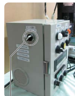
●制御盤機側スイッチ *トルク及び回転数を4データ分、 即座に切り替える事が出来ます。
