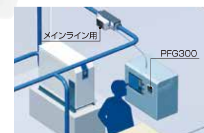
離れた場所に設置の フロースイッチの流量確認が可能!
