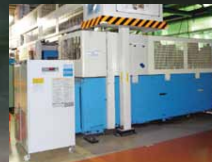
CNC施設に搭載の浸漬型チラー更新例
