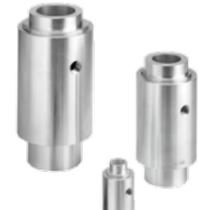
圧縮空気の供給により大流量ブロー&バキュームが可能なバキュームフローを発売しました。供給エア4倍の吐出流量を発生させることが可能で、流量が必要なブローでは消費流量の削減に貢献できます。また、供給エア3倍の吸込流量を発生させることが可能で、流量が必要な吸込では消費流量の削減に貢献できます。4サイズの通過径を用意しており、大きな通過径で切屑、ごみ等の吸込が可能です。電気式プロアと比較してモータの定期的なメンテナンスが不要です。取付ブラケットを用意しています。水滴の飛散、切粉の吹飛ばしなどのブローや半田煙の吸煙、ペレット・粉体等の材料搬送などのバキューム用途に適用します。
