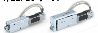
小形・軽量の電動アクチュエータを開発しました。ロッドタイプ(LEPYシリーズ)は質量240g、スライドテーブルタイプ(LEPSシリーズ)は290gで、最大押当て推力:50N、繰返し位置決め精度:±0.05mm、位置・速度・推力の設定(64点)が可能です。また、用途に合わせて高推力タイプ、小形・軽量化にすぐれたモータコンパクトタイプのモータ選択が可能(サイズ10のみ)。さらに短ピッチ取付が可能です。ステップデータ入力タイプ、プログラムレスタイプの2種類の専用コントローラを用意しました。ピックアンドプレース、整列、払い出し、圧入などの用途に適応します。横方向、縦方向、軸方向など多方面からの取付が可能で、モータケーブル取出は4方向から選択可能です。
