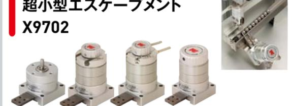
連続して流れてくるワークの分離が簡単にできるエスケープメントに、本体サイズ□32mmの超小型タイプが登場しました。最高頻度180cpmと300cpmで微細部品搬送工程の分離に最適です。1駆動で2つのスライダを正確に分離動作させるので制御が簡単です。また、カムによる動作なので移動端でのショックがなく耐久性に優れています。手動調整用ハンドルを使えば、取り付け時の位置調整が手動で確認できるので便利です。タイプはアクチュエータ駆動でハンドル付きの「基本モデル」とスライダ後退確認センサと手動ハンドル付きの「センサ付モデル」、モータ駆動でエアレス環境に対応可能な「外部入力モデル」の3つから選べます。
