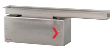
エア式のピストンバイブレータを利用してトラフに振動を与えることで、ワークを進行方向に跳ね上げ、落下を繰り返しながら輸送する振動輸送機器です。ベルトコンベア輸送のように、投入したまま山状でワークが流れるのではなく、トラフ全面にワークが広がり、上下の重なりが自然になくなる特性を持っています。また、輸送能力の調整はエアの圧力調整でコントロールできるため、現場のラインに必要な輸送量に調整可能です。トラフにステンレスSUS304を使用してワーク接触面は#400に仕上げられています。ピストンバイブレータ収納部も同じくステンレスのカバーを設けてあるため、防塵性にも優れています。
