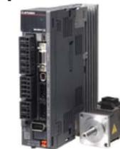
「安全、そしてエコ。目指すのは速度だけではない。いま、人・機械・環境と響きあうサーボへ。」をコンセプトに、機能・性能の進化だけでなく、安全・省エネ、従来機との互換性にも重きを置いたMELSERVO最新作です。2.5kHzの速度周波数応答、22bit高分解能エンコーダなど基本性能が大幅に進化。また2つの低周波振動を同時に抑制できる制振制御、機械共振抑制フィルタなど、高度なゲイン調整もワンタッチオートチューニングで容易に行うことができます。更に今後リリース予定の各種変換ツールを用いることで、長年ご愛用頂いておりますJ2S・J3シリーズとの連携や置換えにも対応可能です。その他にも安全規格対応や予防保全機能、再生電力活用による省エネ化など、ユーザー目線に立った自信作です。
