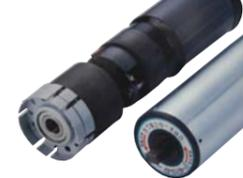
ローラーの回転で発生する遠心力により自動的にブレーキ作動するメカニズムです。MBR(メカニカルブレーキローラー)とは、搬送物の移動によるローラーの回転をギヤで増幅することで、ブレーキ部に発生する遠心力で自動的にブレーキが作動するしくみのスピードコントロールを内蔵しています。動力を一切使わないため、重力を利用した究極の省エネ・ブレーキローラーといえます。作業者の操作負担の軽減はもちろん、搬送物に損傷を負わず事なくやさしく減速・停止させることができます。自走コンベヤの低速搬送や暴走防止に、方向転換機や移載機前の減速など、いろいろなシーンで用途は広がります。
