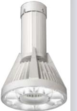
メタルハライドランプ400Wを超える高出力タイプの高天井用照明です。業界最高レベルの器具光束24,000lm、器具効率111.6lm/w(広角配光タイプ)を実現。メタルハライドランプ400Wと比べ、約53%の省エネを達成しました。また、器具本体部にマグネシウム合金を採用することで、6.5kgと軽量化とコンパクト化を実現しました。照明設備の改修による建物への影響・負荷を抑制します。さらに、初期光束補正機能により、寿命末期まで一定の明るさを維持し、無駄な明るさ・電力を抑えます。ただ省エネだけでなく、長寿命(60,000時間)を実現しているため、従来ランプ交換にかかる費用や手間でお困りだった工場・倉庫や体育館の高天井施設向けにお勧めしたい商品です。
