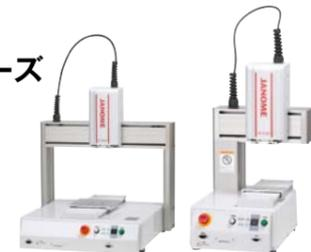
充実した塗布機能と簡単ティーチングが特長で、コストパフォーマンスの高い最新モデルです。特長としては①動作範囲200×200mmと300×320mmの2モデル②振動が少ない滑らかな動作なので塗布作業に最適③位置やパラメータの設定だけで簡単にティーチングが可能④点塗布や線塗布の他、矩形や円の塗りつぶし機能を装備。また、線塗布の開始点または終了の塗布欠け、塗布終了時での塗布剤の糸引きを防止する設定も可能⑤塗布剤のノズル詰まりを防ぐために、塗布剤を吐出させるスイッチを装備。また、1サイクル運転終了後に自動で吐出させる設定も可能⑥表示言語は10ヶ国語に対応などです。
