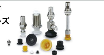
真空パッドに新たにZP3シリーズが追加されました。全長寸法を従来品(ZP)との比較でパッド単体で最大9mm、アダプタ付で最大11mm短縮しました(平行、パッド径φ2の場合)。φ2チューブ配管適用により、取回しスペースの削減が可能です。パッド径φ1.5を追加し、φ1.5~φ16、平行・平行溝付、ベロウ形のバリエーションを用意しています。また、ワークの離脱性向上、アダプタからのパッド抜け防止機構、識別性の向上、インロー付きで容易な取付と再現性を実現しました。パッファボディのコンパクト化により最大55.5mm全長短縮(パッド径φ8、平行、ワンタッチ管継手付の場合)、パッファのショートストローク対応で3mmを追加しました。配管バリエーションではおなじみ、めねじに加えて、φ2配管に対応するバンプ継手、ワンタッチ管継手を追加しました。
