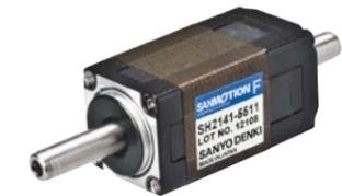
業界最小・最軽量※を実現した2相ステッピングモータです。取り付けフランジ角14mm×14mm、質量28gを実現しました。電動グリッパ、電動シリンダなどのモータをインストールするスペースが小さい装置に最適で、装置の小型化が図れます。また、ホールディングトルクは0.0065N・m以上と高トルクです。片軸シャフト・両軸シャフトをラインアップしました。
