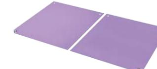
ゲル状ポリウレタンの自己粘着性と柔軟性を利用した「クリーンマット」です。靴底の段差に密着し塵埃を捕集、水拭きで汚れが取れ、乾けば粘着力が元に戻ります。ドアの開閉時に邪魔にならない3mm厚、不織布をはさんだ3層構造、高強度台車が通っても破れにくくなっています。識別ラベルで裏表を表示、汚れ具合に応じて裏返して使用することができます。フック穴付きで吊るして乾燥させることができます。半導体工場、電子機器製造、精密機械製造、食品製造、包装資材製造、印刷、塗装、製薬工場、医療施設などで、クリーンルームの出入口・エアシャワーの床面・台車通路に塵埃の侵入防止用として使用したり、粉体や毛埃の飛散防止にデスクマットとしても使用が可能です。
