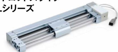
モータ横取付により全高48mmを実現した薄形フラット形状の電動アクチュエータを開発しました。フラット形状により大きいワークでもモータ部への干渉がありません。シンプル構造で、すべり軸受、ボールプッシュ軸受の選択が可能です。対応モータはステップモータ(サーボDC24V)。上面カバー付のベルト駆動タイプで、最大ストロークは1,000mm、搬送速度は1,000mm/sに対応します。また、リミット確認用、中間信号確認用オートスイッチの取付が可能です(オーダーメイド仕様)。ステップデータ入力タイプ、プログラムレスタイプの2種類の専用コントローラを用意しました。ワークのロード・アンロード搬送、ピック&プレースなどの用途に適応します。
