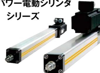
空気圧および油圧シリンダに代わって、各種の生産プロセスへの信頼性向上や各種用途への対応を実現します。空気圧・油圧に比べて、位置決め精度・静音性の高さなど、優れた各種ソリューションを提供します。豊富なアクセサリとそのラインナップにより、各種用途へ適応可能です。主な特長は①最大90%の機械効率②最大ストローク1,600mm③高推力25,100N④繰返し精度±0.03mm⑤最高速度1.7m/secなどです。アプリケーションは、電動プレス、電子部品成型、コネクタかき、自動車関連評価・計測装置、医療用ベッドなどです。
