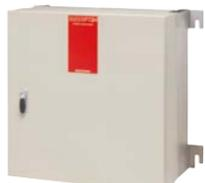
国内向け10kW太陽光発電用パワーコンディショナ「SANUPS P73H」に、停電時にも電力を供給できる自立機能付きを追加しました。一般的な系統連用の産業向け太陽光発電システムは、商用電力が停電すると、電気を供給することができません。本製品は、停電が発生しても太陽光発電から給電ができるため、万一の停電時にも非常用設備に電力を供給できます。オプションのトランス盤を使用するとAC100V(単相2線)で出力できます。高変換94.5%です。入力電圧範囲はDC150~600Vで、さまざまな太陽電池に使用できます。
