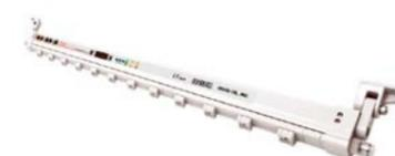
ハイエンドな液晶基板製造工程から、クリーンベンチやクリーンルームでの空間における静電気除去、高速で走行するシートやフィルムの巻き取りなど、広範囲でさまざまな除電の要求に対応できる高性能なバー型イオンナイザーです。ボディの汚れを防止し、針交換がワンタッチで交換できるクリーン設計。超コンパクト・軽量設計で、クリーンベンチ内や製造装置内で場所を問わず設置できます。急速な除電が可能なパルスACコロナ放電式を採用、用途に応じた周波数の変更や印加電圧の調整が可能で、イオンバランスの自動調整機能付きです。針電極の清掃時期をお知らせする針清掃タイマー、高電圧の出力に異常時に点灯する高圧異常ランプ付きでメンテナンス機能も充実しています。
