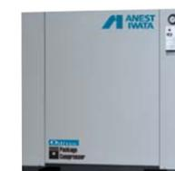
潤滑油を全く使わないオイルフリー式なので、空気はいつもクリーン。食品・薬品・医薬品・印刷・塗装など高品質なクリーンエアが必要な場合にお勧めです。オイルフリーでありながら最高圧力は1.4MPaまで対応しており(5.5kw以上)、高圧が必要なお客様にもご不便をおかけしません。また、クランク室内への粉塵の侵入を防ぐ防塵フィルターキットを標準装備しています(5.5kw以上)。万が一のトラブルを未然に防ぎます。さらに、アネスト岩田が開発した独自のコンポジット樹脂ピストンの採用により、メンテナンスサイクルが延長されました。また耐熱性熱硬化樹脂を使用しているため、高温の連続使用にも耐えられるようになり、コンプレッサに致命傷を与える焼きつきやカジリなど故障の不安を解消しました。
