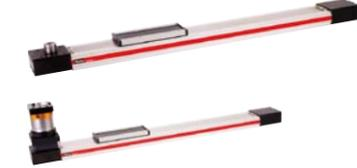
ロングストロークの高速搬送、位置決め用途に最適な電動ベルトドライブアクチュエータです。リニアガイドを内蔵し、容易に装置へのインストールが可能であり、耐食性アウトターバンド採用し、異物が侵入しにくい構造になっています。主な特長は①最大速度10m/sまでの高速動作に対応②最大7mまでのロングストロークが可能③2タイプのリニアガイドから選択可能(高負荷搬送=ボールベアリングガイド)(ロングストローク/高速動作=ローラガイド)④サーボモータの組み合わせ自由などです。アプリケーションは、プレス部品搬送、スリッター、リフター、部品ハンドリングシステムなどです。
