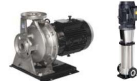
直動形ポンプとして業界で初めてプレミアム効率モーターを搭載したFSD-B・LPD-B型に続き、今回、ステンレス製のFDP-E型とEVM-E型を発売しました。プレミアム効率モーターは、国際規格であるIEC規格における「IE3」に相当するモーター効率を有しており、国内の高効率モーターの規格「JIS C 4212」の効率基準値を上回るモーター効率を実現しています(JIS C 4212はIEC規格の「IE2」に相当)。取り合い寸法は、標準モーター搭載のFDP・EVM型と合わせていますので、既設のFDP・EVM型との交換も容易に行うことができます。
