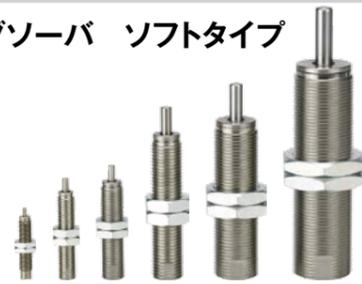
搬送物のソフト停止を実現するショックアブソーバ ソフトタイプにM6、M20、M27の3サイズが追加されました。追加により幅広い使用領域での使用が可能になりました。さらにキャップ付タイプも同時追加設定。RBシリーズと取付互換があります。独自のオリフィス構造により、滑らかな吸収特性を実現し搬送物の衝撃を緩和します。標準ストロークLタイプ(0.05~1m/s)、標準ストロークHタイプ(0.05~2m/s)、ショートストローク(0.05~1m/s)と衝突物質量、衝突速度に適した選択が可能です。エアスライドテーブルなどショートストロークアクチュエータのタクトタイム向上が図れます。
