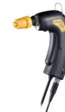
イオンを発生させる高電圧トランスを内蔵したコンパクトな静電気除去エアガンです。イオンを発生させる高電圧トランスをエアガン本体に内蔵し、使用電圧は低電圧DC24V、安心してお使いいただけます。ノズルは工場における騒音値の低減につながる消音タイプ。電源ケーブルは広い範囲での作業に対応できる5m長さで、耐屈曲性のあるロボットケーブルを採用、エアガン本体を接続するコネクタ部は揺動に強いものにして耐久性を向上させました。高圧吹き飛ばしに適した圧力で良好な除電性能を持っているので、塗装工程前の除電・除塵・帯電による強固な塵埃の吹き飛ばしや、塵埃付着防止のための除電など、大きな樹脂製品の除電除塵に最適です。
