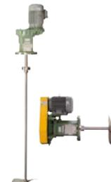
攪拌機の心臓部「攪拌翼」に新たなスーパーミックス翼を兼ね備え、より強力・コンパクトになった高性能汎用攪拌機です。S2グランドバックキタイプで全長を従来型より15%小型化。軸封部はオープン、グランドバックキなど充実。メカニカルシールには新たに簡易脱着構造が加わり、交換時のメンテナンス性も向上。オプションでボディをステンレス製とすることもできるため、衛生的です。オリジナルの高性能攪拌翼「スーパーミックスHR700」、「同HS400」を採用して、攪拌効率も高めました。また、本体構造の見直しで、従来型より1サイズ下の機種でも同等の攪拌が可能。高効率インペラとの相乗効果によるコストダウンも見込めます。
