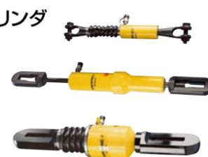
単動式のクレビス付油圧引きシリンダです。能力は105~505kNまでの4種類をラインアップしています。シリンダ内部のスプリングでプランジャが戻ります。強力な伸長力からロッドの破損を防ぐことができる高い強度をもつ合金構造で引っ張り、位置合わせ等の作業に最適なシリンダです。プランジャワイパーが装備されておりシリンダ内部への異物混入を防げる構造です。プランジャにハードクロムメッキを施しているため耐久性が飛躍的に向上しております。対環境対策用としてロッドを防護するゴム製のジャバラが装備されている機種もご用意しております。(BRP-306を除く)
