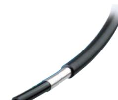
UL-94規格V-0相当の難燃性チューブです。SMCのFR2層ポリウレタンチューブTRBUシリーズ比約2倍と耐スパッタ寿命を向上し、アーク溶接等の火花帯囲気での一般空気圧および水配管に対応します。外層(難燃性ポリオレフィン樹脂)とインナーチューブ(ポリウレタン)の間にアルミラミネートフィルムの中層を設けて3層構造にすることにより、耐スパッタ寿命が向上しました。カラーバリエーションは黒、白、赤、青、黄、緑の6色、インナーチューブ外径6mm、8mm、10mm、12mmの4種類を用意しています。
