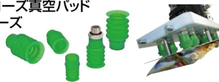
柔軟性に優れたシールリップをもつ4.5段のベローズパッドです。柔らかく、内側にサポートの付いたシールリップは、パウチ袋をはじめとする表面が不安定なワークに対してよく追従します。またベローズとシールリップの間には適度な段差があり、パッド圧縮時にシールリップがベローズと接着し、硬くなるのを防ぎます。その結果、搬送中もシールリップの柔軟性が持続し、安定した搬送が可能になります。機械との取付方法は平行ネジの他、標準サイズのパイプに直接差込もことができるため、接続が容易です。パッドの口径は大きく、ポンプやフロア、マルチステージエジェクタなど流量の多い真空発生器に最適です。流量を絞らずに吸着できるため、素早い真空到達が可能となり、1分間に100サイクルという高速搬送を実現します。材質にはFDA対応のシリコンゴムを使用しており、直接食品を吸着して搬送することも可能です。
