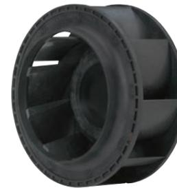
保護等級IP54の防水・防塵性能を持った防水遠心ファンです。屋外などの厳しい環境でも、安定した冷却性能を保ちます。省エネルギー・低騒音でありながら、高風量・高静圧も実現しています。φ100mm×25mm厚、φ133mm×91mm厚、φ150mm×35mm厚、φ175mm×69mm厚の4サイズをラインアップしました。移動体通信の基地局など屋外で使用する装置や、熱交換器に最適です。
