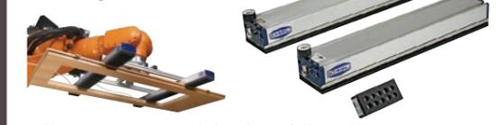
吸着面にスポンジを用い、真空発生器を内蔵したグリッパーです。スポンジがワークの形状に沿って柔軟に追従するため、ワーク表面の粗さや凹凸に左右されることのない搬送が可能です。パレットのように隙間がある製品や、表面に凹凸のある鉄板、プラスチック、段ボール箱など、従来吸着搬送が困難だった製品を始めとする多彩なワークの搬送を実現します。スポンジに開いた吸込み口にはバルブを内蔵しており、各バルブが個別にエアを制御します。ワークに覆われていない吸込み口がある場合にも、エア漏れによる空圧低下が起こらないため、穴・隙間のあるワークや複雑な形状部品も搬送できます。ハンドを変えずに形状やサイズ、数量の異なるワークの搬送も可能です。また効率の良い高吸込み量の真空発生器を搭載しているため、新たに真空発生器を設置する必要がありません。
