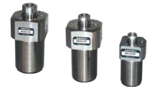
ばねクランプシリーズは、シリンダに内蔵してある強力なばね力によってワークをクランプします。油圧はクランプを解除するときに使用します。長時間クランプや、万一の油圧リークに対してクランプ力低下の心配がありません。MRSシリーズは強力コイルばねがクランプ力を維持します。アンクランプは油圧が使用されます。単動設計で油圧システムのセットアップが簡単です。中空式のプランジャにより治具への取り付けが容易です。またプランジャ先端ネジにサドルを取り付けてワークピースを直接クランプすることが可能です。本体がネジ式なのでシリンダを固定プレートに直接、簡単に取り付け可能。高さ調整も容易です。
