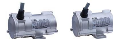
食品・化学・医薬品業界などに適したオールステンレスボディを採用し、水掛け洗いや可能な高い気密性を実現した超小型の振動モータです。単相100VのEKM1S-2Pは全幅110mm、三相200VのEKM1.1-2Pは全幅128mmと非常にコンパクトでボルト(M6)2本で取り付けが出来るので小型容器やシュートの付着や詰まりを防止、ほぐしの効果を与えて閉塞解消や、充填用のテーブル振動機など様々な用途に使用可能です。また、EKM1.1-2Pは汎用インバータを使用することで振動の用途、目的に合わせて振動数を調整できるので振動選別や振動搬送など更に幅広い用途に使用可能です。
