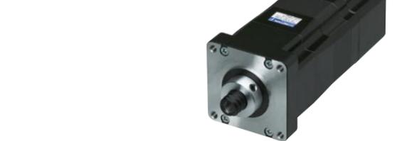
5相ステッピングモータにボールねじを一体化してコンパクトに収めたりニア駆動ステッピングモータです。モータとボールねじが一体化されているため、装置の小型化に貢献できます。業界トップの最大推力450Nとストローク長80mmを実現しています。フランジサイズは42mmと60mmの2機種、それぞれブレーキ無しかブレーキ付きをお選びいただけます。半導体製造装置、一般産業機械、工作機械、搬送機器などに最適です。
