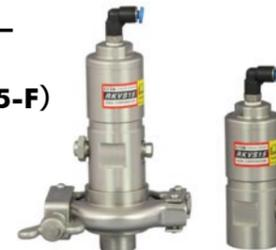
従来のステンレスノッカーでは取り付けが難しい狭い場所や、溶接が出来ない場所への取り付けを可能にした超小型SUSノッカーです。圧縮エアの力でピストンがベース面を勢よく叩き、その衝撃によって粉粒体の詰まりや付着防止に非常に効果的です。また、ボルト(M10)1本で取り付け出来るRKVS15型、工具を使わずに手作業で取り付け・取り外しが出来るヘルル継手固定式のRKVS15-F型の両機種共にボディ・ヘルル継手などに錆びにくいステンレス材を採用しているため食品・化学業界や耐食性を要求される現場の取り付けに最適です。
