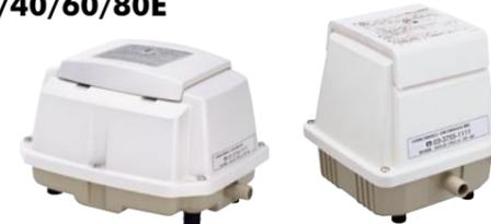
ブロウシリーズの吐出空気量30,40,60,80ℓ/分タイプを改良し省電力化しました。ピストンのストロークをより最適化することで、消費電力を下げることに成功しました。60ℓ/分タイプでは最大25%の省電力化を実現(日東工器比)。電気代の節約とCO2(二酸化炭素)の削減に貢献します。長寿命・低作動音・アース不要のため、浄化槽・養魚等いろいろな空気供給用途に活用できます。なお、当製品は「低炭素社会対応型浄化槽整備推進事業」に対応しています。
