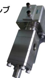
超高压用エアオペレート式切替弁です。既存の10MPaタイプ発売後、特にご要望の多かった50MPaタイプを新たにラインアップしました。ポンプメーカーとしてのノウハウを活かした商品で、超高压・大容量の流体を瞬時に切り換えることができます。流体圧を利用した独自のシール構造を採用し、切替時に負荷のかかるシールを長寿命化、耐久性を向上させました。最大使用圧力50MPa、最大通過水量300L/min。工作機械用高圧クーラントや高圧洗浄液、燃料ラインの切替に最適です。少量のコンタミを含んだ液にも使用可能です。(特許出願中です。)
