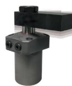
90°旋回ストロークが0mmの省スペース形のスイングクランプで、「コンパクト」「ハイパワー」「ハイスピード」を兼ね備えています。ダブルインターロック機構を内蔵し、誤動作を確実に防止しています。スピードコントロールバルブをクランプ毎に直接取り付け可能で、複数台クランプの同期・スピード調整が容易です。従来標準品LHAとクランプ力、取付寸法は同等です。
