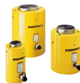
重量物用の単動シリンダです。70MPaでシリンダ能力としては539~10260kNをラインアップしています。シリンダからプランジャが抜けるのを防ぐストップリングが装備されています。シリンダ能力の10%までの横荷重に耐えることができる独自の軸受け構造設計で溝付きの焼き入れサドルがジャッキアップの負荷からプランジャを保護します。ピストンプランジャにはメッキが施されており腐食防止構造になっています。建物、橋などの大型建造物のジャッキアップなどにお勧めです。
