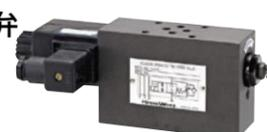
電磁操作ストップバルブと、スロットルチェックバルブを組み合わせた複合弁で、電磁操作により、流量を2段階に切替えることが可能です。電磁操作によりアクチュエータの2速制御が可能です。接続方式はモジュラー形なので、2速回路のコンパクト化に最適です。工作機械の送り制御に最適なバルブです。
