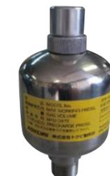
コンパクトで軽量を特長としたステンレス製アクムレータです。配管機構内での流体の圧力を一時アクムレータに蓄えることによって脈動現象を抑え、スムーズな排水・給水活動をサポートします。耐圧性に優れておりコンパクトで軽量なため配管設計に自由をもたらします。材質はオーステナイト系ステンレスのSUS316Lを使用、高耐蝕性・高耐薬品性を実現致します。
