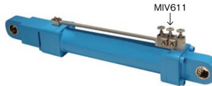
油圧開閉装置の不具合箇所の診断・作業等を容易にする多機能弁です。油圧回路の監視機能、フラッシング回路の構築、油圧シリンダパッキンの良否判定、埋設配管の漏れテスト等を容易に行えます。これらの機能を強固な弁体にコンパクトに収めており、油圧シリンダへの組込みも無理なく行えます。配管数は多機能弁への2本のみ、現地工事も簡略化と工事日数の大幅な短縮が図れます。「油圧シリンダにMIV611弁を取り付けることで、新油及び更替時の空気抜き作業が容易になります。」メンテナンスの困難な配管(増設配管等)やシリンダの油漏れの確認が短時間で済みます。
