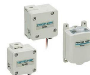
小型・大容量ダイヤフラム式ポンプをリフレッシュしました。幅広い液体の移送、回収に適した手のひらサイズのダイヤフラム式ポンプです。小型・軽量で体積は25%減(従来PBシリーズ比較)、長寿命1.5倍(同)、吐出量8~2000ML/min、質量0.11kg(PB1013Aの場合)です。ダイヤフラム式により低発塵で、エアオペレート型は可燃性液体で使用可能です。自吸式で呼び水が不要なため、ポンプ内が乾燥状態でも液体を吸い上げます。クリーンルーム組立、2重梱包です(PB1313A)。電磁弁のON/OFF切替頻度で流量調整が容易に出来ます。
