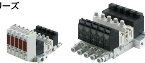
弁応答5ms、真空応答時間28ms(SMC比25%減)と高速応答タイプです。空気消費量17%減、到達真空圧力21%向上(従来機種比較)と省エネ設計です。供給弁、破壊弁、破壊流量調整ノードル、サクシオンフィルタ、サイレンサを搭載したオールインワン設計です。46g(単体質量)と小型・軽量化を図りました。最大10台まで同時コピー可能な真空用圧力スイッチ付を用意し設定工数削減、設定値の入力ミスを低減します。破壊圧供給ポート付を選択した場合、空気圧と破壊圧を個別に調圧が可能です。大気開放口により破壊応答時間を25%短縮しました。
