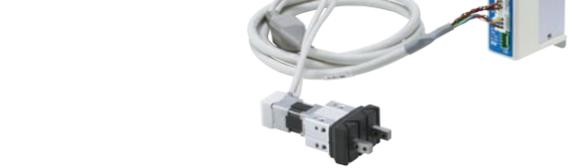
電動グリッパ2爪タイプにダストカバー付を追加しました。IP50相当の密閉構造ダストカバーにより切粉・粉塵等の内部侵入を防止し、グリスの飛散等を防止します。クロロブレンゴム(黒色、標準)、フッ素ゴム(黒色、オプション)、シリコンゴム(乳白色、オプション)の3種類のカバー材質を用意しました。閉鎖時にカバーによる突起が出来ない内部構造のため、他の機器との干渉を防止します。落下防止機能付(全シリーズセルフロック機能付)、セルフロックにより消費電力を低減する省エネ設計、寸法の異なるワークの識別・着脱検出可能な把持確認機能付です。位置・速度・力の設定は64点可能です。
