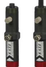
往復リニア運動で高振幅振動を得られる為ホッパー・タンク・配管シュートの付着閉塞防止機器として高い性能を発揮するエア式バイブレータです。同じ閉塞防止機器のノッカーシリーズやボールバイブレータシリーズと比較して、運転音が静かでエア消費量少なく環境に優しい構造です。従来のピストンバイブレータEPVシリーズと構造が異なり、ピストンがシリンダ外部まで飛び出している為、高ストロークの運転で振幅が大きくなります。また、取り付け方向を上下逆にする事で2種類の振幅が確保出来ます。
