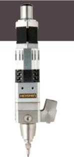
高粘度液をμL(※マイクロリットル)レベルで自在に流量制御できる新しいタイプの微量吐出装置です。ヘイン独自の軸偏心ねじ構造を基本とし、さらにサーボモータと精密減速機を採用することによって、微量吐出量の制御を可能にしました。特に3HD010G30は0.1μLレベルの微量領域でも、設定通りの塗布量を瞬時にかつ高精度に吐出することができ、高粘度液を微量で塗布・充填・封入することができます。吐出完了後瞬時に逆転させることで液切れが良く液ダレがなくワーク(塗布対象物)や周辺機器を汚さずに効率良く作業が行えるので、各種ロボットに搭載することで、塗布作業を高精度にかつ効率的に行えます。(※1μL:1×1×1mmの立方体の体積)
