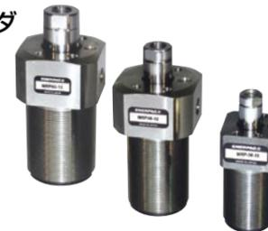
単動式の油圧引きシリンダです。シリンダ内部のスプリングでプランジャが戻ります。ワークの脱着頻度が多い生産設備に最適な単動式引きシリンダです。プランジャが中空のため器具への取り付けが容易です。プランジャ先端にアタッチメント取り付け用のメスねじがついております。シリンダ固定方法はシリンダ上面4箇所の取り付けネジとシリンダボディ外径ねじを利用して簡単に取り付けられます。引きストローク15mmでシリンダ出力は10.3~25kN、プランジャ径は16mm、22mm、30mmの3種類を用意しております。
