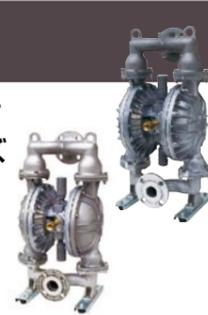
従来のダイヤフラムポンプの特長に加えて、駆動エアのロスを抑えた仕様で、業界最高の材料の押込み高圧力を実現しました。また、高圧から低圧まで、運転圧力範囲が拡大し、低速運転にも安定したストロークを実現し、エア供給の不安定な現場でも、超低圧作動により、搬送材料への負担を最小限に抑えます。従来からの特長である①先止め、吐出流量、吐出圧のコントロールが簡単②完全自吸式、空運転も可能③防爆対策は不要④軸シール部がない、グランドレス仕様⑤スラリー液、高粘度液も移送可能⑥メンテナンスが簡単。一般工場、化学工場、製陶工場などの液体の移送、循環、フィルタプレスなどに最適なポンプです。ヤマダはアフターも万全な体制でサービスに努めています。
