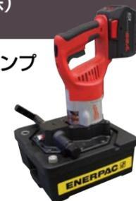
軽量でコンパクトなバッテリー式油圧電動ポンプです。28Vで大容量リチウムイオンバッテリーを採用し、70Mpa、ストローク52mm、能力233kNのシリンダの場合は最高出力で8回使用可能です。タンク有効油量1.9もしくは3.8ℓでロングストロークのシリンダにも使用可能です。トリガー引きストロークを変えることでモータ回転数を簡単に可変できるのでシリンダやツールの動きを微調整可能です。動力源は、バッテリーのためコンセントをつなぐことなく自由に現場に持ち運べます。従来のバッテリー駆動式の油圧ポンプは、バッテリーの容量の関係で重量物・長時間稼働できませんでしたが、BPシリーズは28Vのリチウム・バッテリー式で重量物を長時間稼働できます。デモ機もご用意しておりますのでお気軽にご連絡ください。
