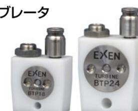
完全オイルフリーで使用するエア式のタービンバイブレータです。使い方も従来のボールバイブレータのように圧縮エアを供給するだけで簡単に振動し、供給エア圧力を調整することで振動数と遠心力を調整することが出来る使い易い振動機です。BTP18は50g、BTP24が90gと非常に小型に出来ているのでちょっとした振動が欲しい場所やホッパーシュートなどの粉粒体の詰まりや付着防止に効果を発揮する製品です。また、高速で回転するタービン部分はケース部分と接触することなく振動を発生させている為騒音レベルも非常に小さく、工場環境に優しいバイブレータです。
