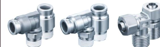
ワンタッチ管継手とインサート管継手3シリーズをリフレッシュしました。現行品と比較して小型・軽量化を図っています。金属ワンタッチ管継手とSUS316ワンタッチ管継手では現行品との比較で寸法比約30%、質量比約62%ダウンを実現しました。SUS316インサート管継手では寸法比約44%、質量比約37%ダウンしています。形状バリエーションを拡大し、ねじ種類とチューブサイズを拡大しました。KQB2とKQG2の使用流体温度は-5~150℃、KFG2は-65~260℃で、KQG2とKFG2は蒸気での使用が可能です。
