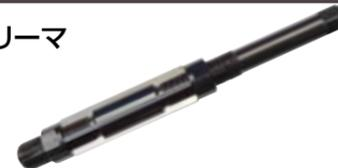
刃をスライドさせることで自在に刃径寸法を簡単に調整することができる替刃式リーマで、摩耗や欠損した場合は新しい刃に交換することで新品同様の切れ味に戻ります。機械加工はもちろん、手作業で使用できますので、現場で緊急に穴径の修正が必要となる場合に、リーマを数種類そろえるのは経済的に負担があるとお考えの方にご検討いただきたい商品です。ブレードの材質は靱性のあるHS Sを採用し、一般鋼、鋳鉄、銅、アルミ、真鍮等の幅広い材料にご使用いただけます。また、欠損したり、激しい摩耗が確認された場合は新しいブレード(替刃/AJR012013)に交換することができます。本体は19種(刃数4~8)揃えており、径調整可能範囲は最少径6.4mmから最大径95mmに対応しております。ブレードの替刃は19種(4枚~8枚入り)を揃えております。ご使用の際は必ず右回転で使用し、リーマ取りしろは、通常φ0.05~1.5mmの間で調整して加工を行ってください。
