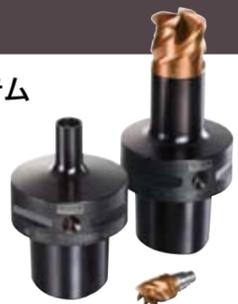
コロミル316、ヘッド交換式工具用に設計されたトルク伝達、振れ、精度に関しては、高精度チャックと円筒シャンクホルダの組合せより安定した性能を発揮します。全体のプログラム長さ(11)はEHインターフェース付き円筒シャンクツールホルダより短くなります。したがって、他のすべての加工変数が同じ場合、コロミルEHソリッドホルダは最高の剛性を発揮します。このモジュラーシステムにより、工具在庫を削減しながら標準品で多くの工具組合せが可能となります。この優れた柔軟性により、セットアップ時間を削減し、ヘッド交換をしたときの工具長の変化が少なく、優れた安定性が保証されます。
