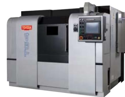
日刊工業新聞「第52回(2009年)十大新製品賞 モノづくり賞」を受賞したTG4に芯間630mm仕様を追加しました。近年、消費者ニーズの多様化によりさまざまな製品分野において製品のモデルチェンジサイクルは非常に短くなっており、生産設備に対して多品種少量生産、リードタイム短縮、高付加価値生産、他ラインへの高転用性などが求められています。このような顧客ニーズを受けて開発したTG4は、2種の砥石を取り付けた砥石台を自動回転させ、複数の加工箇所を有する円筒工作物を1台で加工することができ、設備台数の削減やワンチャッキングによる加工精度向上を実現しました。また、工程集約により初期設備投資費用だけでなく、保全費、刃具費等も含めたランニングコストも大幅に低減。機械占有スペースは5.8m<sup>2</sup>と、クラス世界最小のコンパクトマシンとして従来機1台分のスペースに設置可能です。
