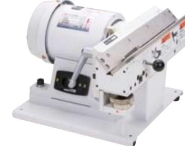
低騒音で安全性に優れ、作業環境に優しい手動式スライドガイドタイプの面取機です。加工物を載せたVガイドをスライドさせて面取り加工を行うため、加工物に引き傷を付けることがありません。円筒超硬スパイラルカッタを使用し、耐久性に優れた美しい仕上げ面が得られます。
