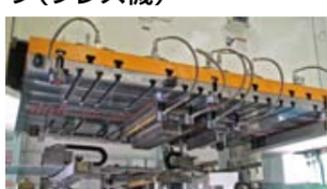
永久磁石(ネオジム磁石アルニコ磁石)で金型を強力にクランプできるシステムです。金型を選ばず、ボタン操作一つで瞬時にクランプできます(油圧クランプに必要な金型取付板の厚さや寸法の統一が不要です)。通電はON/OFF時のみで、クランプ中は電力を消費しません。万が一、停電やケーブルの断線が起こっても、金型(上型)は落下しません。金型のセンターを強力にクランプできるため、金型のたわみが防止でき、成形精度が向上します。また、ボルトレスにより、外段取りが迅速に行なえ、金型交換作業の負荷軽減と安全性の向上が図れます。大型プレススライド・ボルスターを始め、ムービングボルスター、ダブルアクションプレス、ダイスポッティングプレスなど各種プレス機への導入実績が多数あります。
