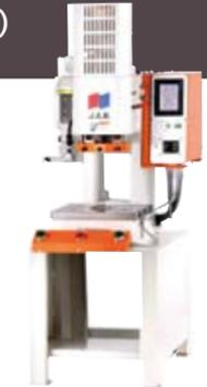
「MFエコマシン認定基準」に基づき開発、認証取得したエコ油圧プレスです。MF基準において待機状態、無負荷運転、負荷運転を従来機種とエネルギー消費比較はHYP505Hで約23%削減、HYP1000で約28%削減しました。インバータ採用により上死点待機状態時はモータを停止します。シーケンサ制御採用により、周辺装置との連動が簡単になりました。エラー表示、作動油交換時期、パッキン交換時期をタッチパネルに表示します。上昇時に生じるソレノイドバルブからの騒音を改善しました(HYP505Hと比較し、6dB低減)。
