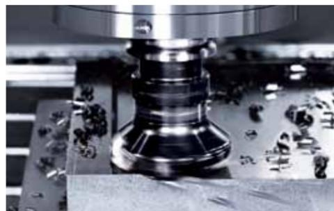
主軸最大回転速度は12000min<sup>-1</sup>と高速で、重切のみならず、小径工具を用いたアルミニウムなどの加工でも高速切削により美しい仕上げ面を得ると共に、加工サイクルタイムを短縮する事ができます。
