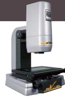
テーブル上のワークをCCDカメラでLCDモニタに映してX-Y座標測定を行い、Z軸も高さのみ測定可能で、投影機と画像測定機を融合させた次世代の非接触画像測定機です。高剛性のグラナイト製本体・支柱と共に、高精度仕上げの測定テーブル・光学システムが測定に最も必要な安定した測定状態を提供します。測定範囲は200×100、300×200の2サイズ、マニュアル式とDCC(自動)の2タイプをご用意しました。TESA-REFLEX Vistaソフトを使用する事で、現場の誰でも素早く簡単に機形状解析が可能になります。またオプションのComparソフトを使用すれば、CADモデルとの形状比較が可能になります。
