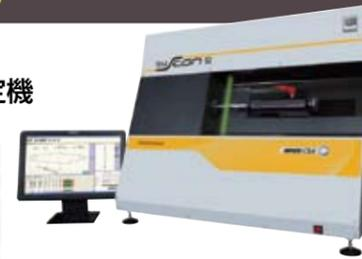
ワークにLED光を照射して出来た影をCCDアレイで検知し幾何形状解析を行います。シャフト形状ワークの測定に困っている、測定項目または測定ワーク数が多すぎて測定時間がかり過ぎるなどの問題を解決する非接触シャフト形状測定機です。シャフトをセットしてボタンを押すだけで自動測定(径、長さ)し、結果を出します。面倒なプログラミングはありません。過去に測定したワークもセットしてボタンを押せば、測定機が自動測定し結果を出します。面倒な位置決め等の作業は一切ありません。静的測定/静的・動的測定可能な2タイプを用意しました。また、従来機種より40%低い価格を実現しました。
