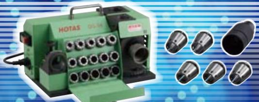
φ11.1mmからφ34mm(オプションコレットを追加すればφ7.1mm～)までのHSS及び超硬ドリルの円錐研磨ができるワイドレンジ。従来機種DG-25型(φ11.1mm～25.4mm)の改良型で25.5mm以上のドリルには大径用のホルダーとコレットを使用することでφ34mmまでを可能にした。既存機種と同じく高精度に加えポータブルで持ち運びもでき省スペース、更に使いやすさも兼ね備えたドリル研磨機です。
