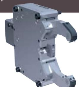
長尺ワーク(例えば、車のカムシャフト等)を加工する際のビビリ止めとして使用します。世界のトップシェアを誇るSLUシリーズをスタンダードモデルとして、このSRはプレミアムモデルと位置付けております。作動方式は、従来のSLU同様の構造ですが、本体内部に切粉等が入らないよう更に完成度の高いシーリングをしました。これによる切粉等の侵入をほぼ完全に防ぐことが可能になりました。そしてエアパージ消費量を95%削減、少量のエア消費でご使用頂けます。また、3本のアームから(SR4以上)吹き出すクーラント等、現在考えられる全ての要求を満たしております。この結果、長期使用が可能となり、精度を長期間保つことが実現できます。
