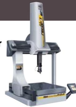
マニュアル測定の動きをそのまま記録(Record)して自動測定に変換できるリーズナブルな価格設定の小型三次元測定機で、小中型部品の連続検査に最適です。この機能によりプログラミング等でオペレーターにかかる負担を限りなく減少させると共に測定時間の短縮が可能です。作業は手動或いはジョイスティックで測定すべきポイントに測定子を接触させ最後にメモリするだけです。その後は、モータ駆動によりマニュアルで測定した通りに自動的に測定が行われます。現場における測定品質と作業効率を飛躍的に向上させる事が可能です。
