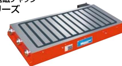
強力な吸着力と良好な釈放性を兼ね備えた永電磁チャックです。フライス、マシニングセンタ等による切削加工時のワーク固定に、とりわけ重切削加工用途に最適です。ワークに磁気が集中する独自の磁極形状により強力な吸着力が得られるとともに、消磁専用コイルの採用でOFF時のワーク釈放性を大幅改善しました。残留磁気が大きな焼入れ鋼や特殊鋼に対しても良好な釈放性を発揮します。電気を使うのはON/OFF時の瞬間通電のみのため、内部発熱がなく省エネです。
