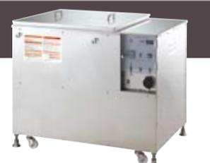
成形金型表面には樹脂の成分を含むガスや、我々が思っている以上に湿気等が含まれています。手作業や超音波洗浄ではこれらをスッキリ取り除くことは不可能です。クリピカエースは、電解ガスとキャピテーションによる振動と、液抵抗を極めて低く組成し、尚且つ汚れの膨潤効果も高く金型にダメージを与えない工夫を施した専用洗浄液との組合せを実現した成形金型専用洗浄システムです。成形金型の金属組織の隙間に含まれた頑固な固着汚れや腐食性物質を短時間で金属表面の水が撥水しなくなるほどまで完全に除去できるので、成形ショット数の伸びや成形不良の削減だけでなく、金型を腐食しにくくして型寿命を延ばす事ができます。また手では届かないような奥まった箇所や長時間を要する手作業での金型メンテナンスから開放される事で労力やコストが低減でき、洗浄液寿命も長く廃棄物発生量が少ない低負荷の低い洗浄システムです。
