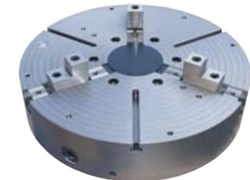
切粉がチャック内部に侵入することを防ぐカバーをチャック上面に装備することで、防塵対策を施しましたので、特に立旋盤でのご使用に適しています。チャック外径はφ535〜1800まで11サイズ、幅広くラインアップしておりますので、加工物に応じたチャックサイズをお選びいただけます。本体材質はチャック外径φ710まではスチール製、φ800以上のサイズは鋳物製になっており、爪は分割爪タイプで硬爪が標準付属されています(オプションで生爪もご用意できます)。
