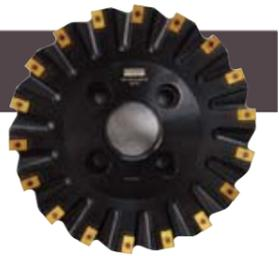
モジュールレンジ12~22の大型ギア用の高性能カッタです。最新のチップ材種との組み合わせによりギア加工時間を短縮し、次工程の加工のための最小限かつ均等な仕上げ代を確保します。高精度で信頼性の高いギアの外径および内径荒加工が可能です。材種は、耐摩耗性・耐チップング性を向上するGC1030と、安定した長寿命を実現するGC4240です。
