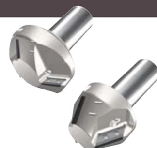
ご好評のCカッターに面取り角度30°と60°タイプが新登場しました。カッター本体が肉厚設計のため、穴径の面取りだけでなく、横送りの面取りにも対応しています。加工範囲が広いのでツール本数および、ツールチェンジ回数を削減できるのでツールボットの有効利用、加工時間の短縮が図れます。クランクノズル付きで、加工点に向け調整でき確実な給油が可能です。シャープな切れ刃と、確実な給油により、従来にない美しい加工面に仕上がりと、溶着しやすい材料、難削材でも安心して加工できます。
