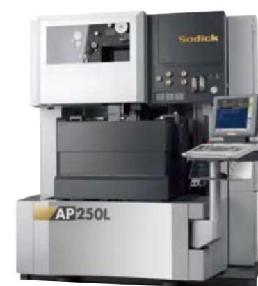
超精密ワイヤ放電加工機AP250Lは、その再現性・安定性を高め、狙い精度とどりの高精度加工を追求できるパフォーマンスを発揮します。加工ニーズに応じた2つのタイプをご用意しており、タイプ1:高速加工に加えて「サビレス」に対応する水仕様、タイプ2:微細領域でクラックレス相当の加工面を実現する油仕様、ともに超精密・超微細領域において定評をいただいております。特長は①4軸リニアモーター駆動②左右対称門型コラム採用の高剛性機械構造③機械の温度分布を一定に保持する定常化構造④操作ユニット集中配置による作業性の向上⑤3次元ソリッドモデルの直接取込対応⑥機電タンク一体の省スペース構造を採用しています。また、本製品は安心の製品保証3年、及び、機械精度10年保証を提供します。
