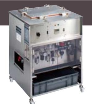
コスト削減の為に成形ショットサイクルの時間短縮や成形品のヒケ・反り・ボイド等の不良対策には、金型冷却水管の定期的なメンテナンスが必須です。冷却水管の出入口だけドリルで擦ったり、塩酸を流してメンテナンスをすると、粉塵や水洗面・中和処理液・塩酸廃棄物が大量に出たり、塩素が発生し周囲にまで錆が及んだりする等の問題がありました。当社はクロスドシステムなのでこれらの問題を解決しました。また、「専用液WR-5」は、錆やスケール等の頑固な付着物を取り除き、洗浄後のエア乾燥で防錆被膜を形成するという画期的な商品です。金型を分解せずにホースを接続して循環させるだけの簡単な操作でお使いいただけます。
