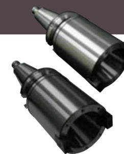
ご好評につきラインアップ。標準サイズのBT(NT)シャンクホルダを延長し、ロングサイズにできます。例えば、BT50-FMA31.75-200に「延長アーバ」BT50-BT50-200を装着するとBT50-FMA31.75-400として使用できます。100~300LはB.Cテック標準在庫品です。その他、別作品も取扱っております。
