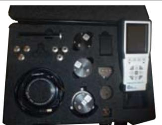
現在お使いのチャックの保持力を静止状態だけでなく回転中もリアルタイムに計測出来ます。このため最適なチャック力で加工が可能です。必要以上の力を使わなくていいので、チャックの長寿命化、エネルギーの節約、つまりは環境に優しい加工が可能です。近年、PL法、安全衛生法やISO9001に従ったメーカー責任、品質保証を含んだ顧客満足度の向上が求められています。更にISO14001では、環境への影響を改善することが要求されています。機械加工に携わるユーザー様におかれましては、機械を最適な条件でご使用されることが、益々要求されてきております。事故防止・品質保証・環境対策のお手伝いをさせていただきます。
