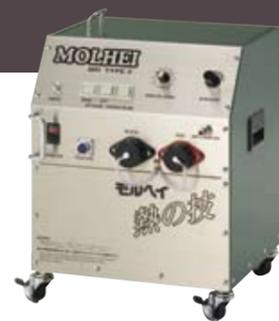
ピンホールやバリ止め、角ダレ等の少量補修に使っていただく電気抵抗熱方式の溶接機です。以下はユーザーアンケートの上位15位までをご紹介します。①「ズ」が出にくい②スパークしない③接触溶接なので失敗が少ない④紫外線が発生しない⑤保護面が不要⑥アルゴン溶接では無理な小さなパーツにも溶接可能⑦ヒケ・ヒズミが出ない⑧持続通電方式なので肉盛りが早い⑨熱変色がない⑩表面処理によっては溶接可能⑪アルゴンガスが不要⑫必要以上に肉盛りしないので後加工が簡単⑬100V仕様なので移動が簡単⑭予熱が不要⑮シム止めにも使える
