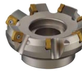
鋳鉄・鋳鋼加工用の高能率正面フライスカッタです。最大8mmの大切り込みが可能で、加工能率の大幅向上を実現します。チップの表裏両面を駆使する「ダブルネガ」設計により、チップ1個で8コーナーが使える高い経済性も特長の一つです。従来のダブルネガタイプのカッタは、経済性と引き換えに、切れ味が犠牲になっていましたが、「DNX」では、高い刃先強度を保ちながらも、鋭い切れ味と高い切屑処理性能を発揮する独自ブレードをチップ刃先に採用したため、高速・高送りでも大切り込みが可能となり、高い次元での高能率加工が実現できます。また、優れた切れ味により、高能率加工にも関わらず、美しい仕上げ面も得られます。
