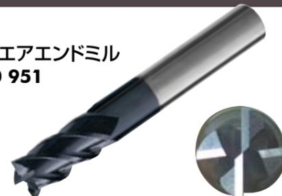
理想的な刃先諸元の不等分割と、難削材加工に最適なコーティングを採用することで、ビビリ抑制長寿命を発揮します。微粒子合金に酸化温度の高いPVDコーティングを施した刃先は耐欠損性を向上、切粉の溶着を防止しスムーズな切粉排出を実現しました。銅合金、アルミニウム合金、チタン合金、耐熱合金、ニッケル合金等、広範囲な被削材にご使用いただけます。スクイ角10°、ネジ角40°刃径φ3.0~20.0mmまで標準化しました。不等分割の静かな切削音、長寿命、切り粉の良さを一度お試しください。
