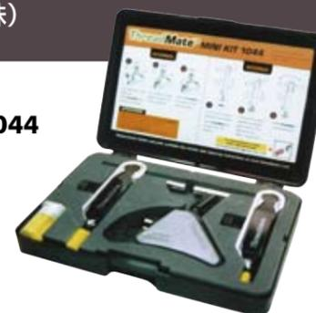
使用頻度の高い、外径4~13mm・内径5~12mmのネジ山修正キットで、ねじ山角度60°のメートルねじ・UN系のインチねじにも使用できます。ナイロンパッド付なので、アルミ等の柔らかいねじにも使用できます。また、替刃交換も容易です。
