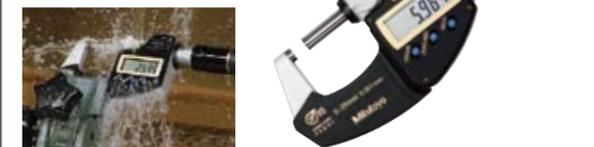
ねじピッチ2.0mmを採用し、シンプル1回転でマイクロメータのスピンドルが2.0mm移動するクイック測定を実現しています。例えば、従来品と比べ、ワークへのアプローチ時間を約60%※1、総測定時間を約35%※削減でき、あらゆる測定シーンで威力を発揮します。片手操作による安定した測定をより充実させた新しい定圧装置ラチェット機構の採用、ミットヨ測定工具の代名詞である過酷な加工現場での使用を可能にしたクーラントブルーフ・保護等級IP65の防水機能等、デジタル式マイクロメータの次世代形です。
