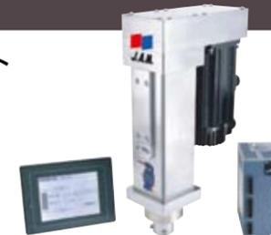
小型のサーボプレスユニットでフリースタイルなレイアウト設計ができ省スペースな自動化ラインを構築できます。操作パネル、コントローラ、サーボプレスのユニットで構成され、コンパクトかつフリーレイアウトで設置場所の制約を受けにくく、自動化ラインへの搭載などに最適です。タッチパネルで速度、停止位置、停止時間を容易に設定でき、段取り時間を大幅に短縮できます。生産性が高いうえ、荷重管理システム(オプション)によってプレス加工の状態をパソコンに表示でき、メモリーカードに記録することでトレーサビリティに対応します。コントローラ(サーボアンプ)がパルス発生機能、アナログ電圧入出力機能、トランジスタ入出力(I/O)機能を有することで、コストダウンを図りました。
