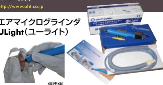
ホースや継手などがセットになっており、購入したその日から使用可能で、メーカー希望小売価格19,800円(税別)、お手頃価格を実現しました。内部設計は上位機種MSG-3BSPPlusを踏襲しており、ハイパワーベーンモータを採用しました。高品質ベアリングを4個均等配置して、高回転と高耐久を両立しました。ボディはガラス繊維強化樹脂製。耐久性を維持したまま78gという軽量化を実現しました。(MSG-3BSPPlusは130g)用途は金属加工向け。主に金型研磨、バリ取り、精密加工など。軽量化のため女性や高齢作業員にもお勧めです。ハードユースには上位機種MSG-3BSPPlusをお勧めします。
