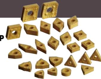
鋼の高速・連続加工用途に最適なコーティング材種です。独自の微細・平滑CVDコーティング「スーパーFFコート」を大幅に厚くすることにより、従来材種比で耐摩耗性を2倍以上の向上を達成しました。刃先縁線部分の強度向上にも成功し、刃先部分の寿命信頼性を大幅に高めました。また、高速・高能率加工における工具損傷の主要形態である「すくい面摩耗」抑制を狙い、コーティング膜の粒度を最適化した「膜厚高強度α-アルミナ膜」を適用しました。すくい面摩耗の大幅低減達成により、従来比1.5倍以上の高速・高能率加工を実現しています。ネガティブタイプ、ポジティブタイプ合わせて329アイテムを在庫ラインアップしています。
