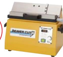
ご好評の面取り器ビーバーカットにコンパクトタイプのBCH200が新登場しました。テーブル移動式なので、ワークを乗せて移動させるだけの操作で直線面取りが、簡単・安全・迅速にできます。フライスカッタによる美しい仕上がりで、面取り作業の合理化、品質向上にお役に立て下さい。デジタル表示により回転数が明確になり、ワーク毎の回転数の微調整が確実です。また、面取量調整グリップを回すことにより面取り量は0.05~4mmの範囲内で無段階に調整することができます。4コーナー使いのスローアウェイ方式のフライスカッタで経済的で、切りくずも集塵装置に吸い取られます。
